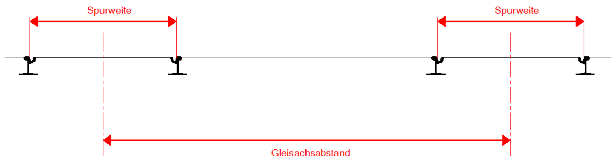
Abbildung 1-27: Gleisachsabstand und Spurweite
