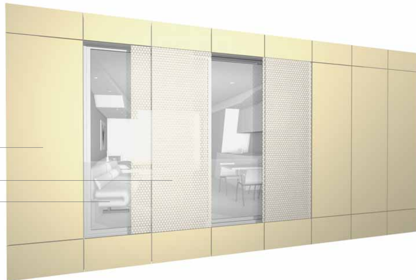
Aluminium-Fassade mit opaken und transparenten, beweglichen Elementen
