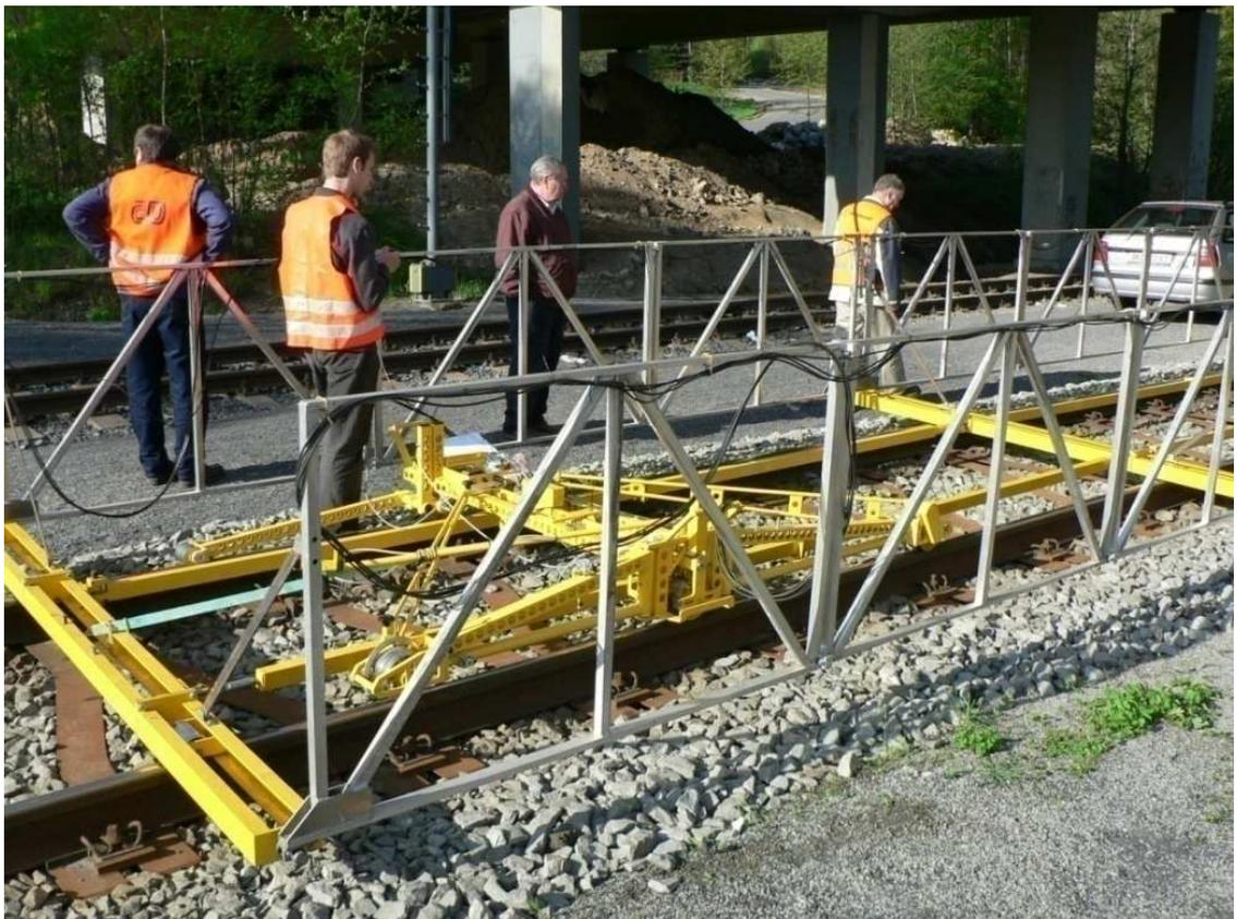
*Abb. 2.8 Messwagen KRAB eingelegt in der Rahmenkonstruktion*
