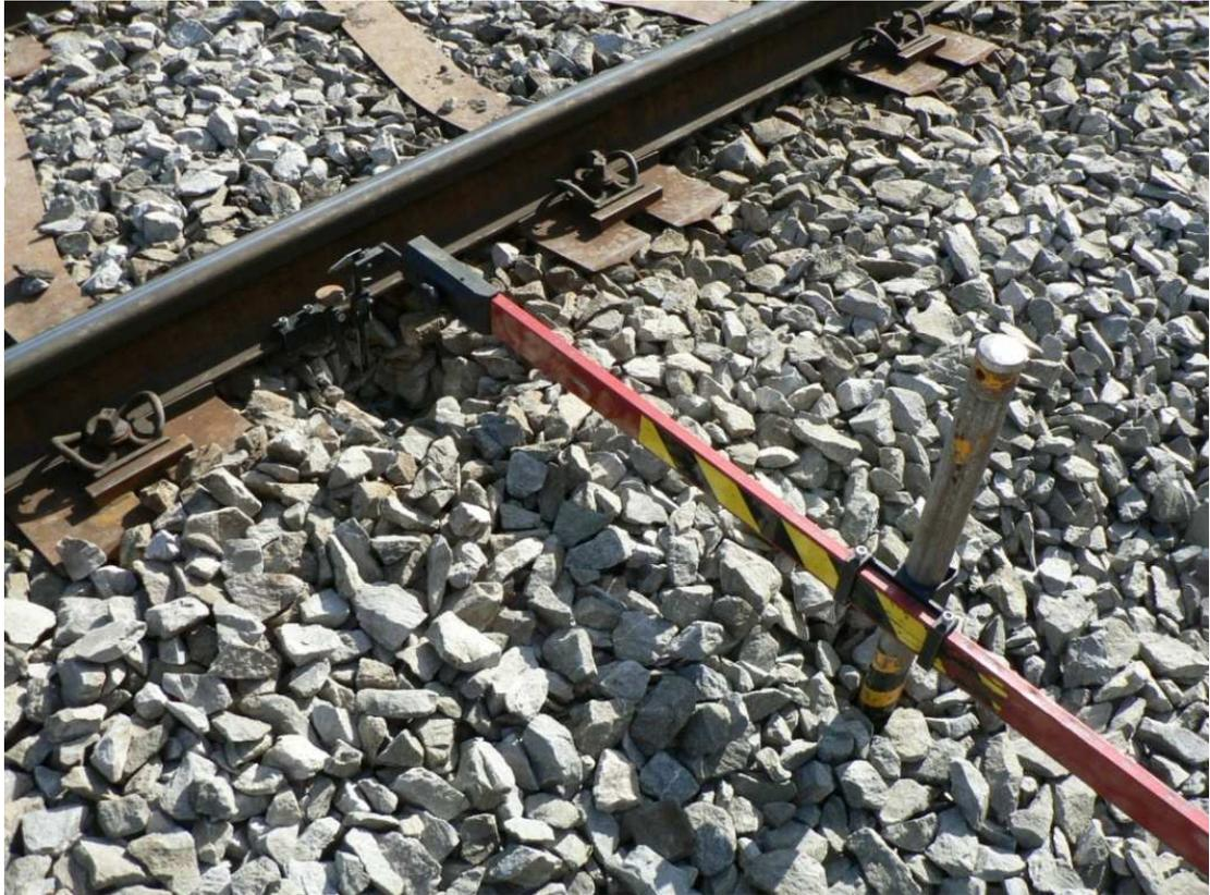
*Abb. 2.7 Messen von vertikalen Schieneneinsenkung mit Hilfe von Schublehre*
