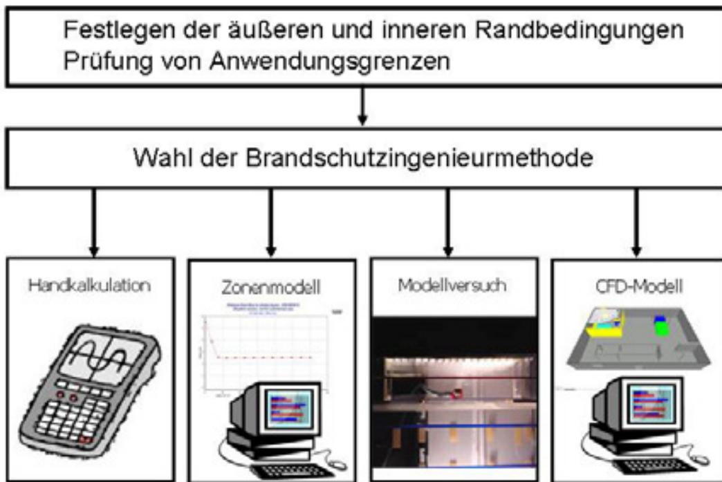
Abbildung 2.4: Vorgehensweise bei der Wahl der Methode zur Auslegung von Entrauchungsmaßnahmen [27]
