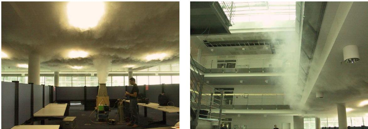
Abbildung 2.5: Rauchfreihaltung eines Atriums - Abnahmeversuch [26]
