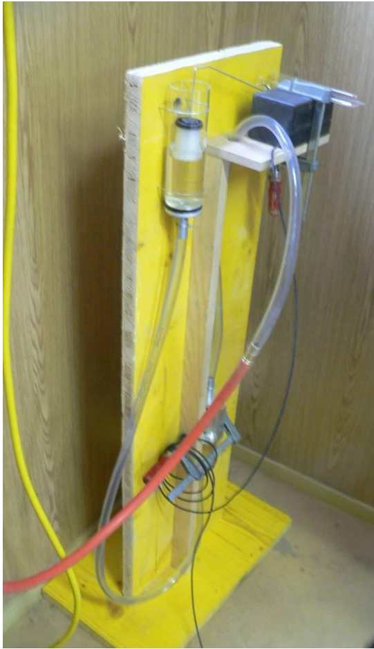
Abb.4.17 Luftdrucksteuerung mittels Schlauchwaage (links) und Gebläse (rechts)
