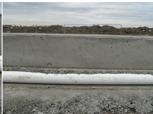
Abb.4.18 Luftlagerung der Betonplatte
