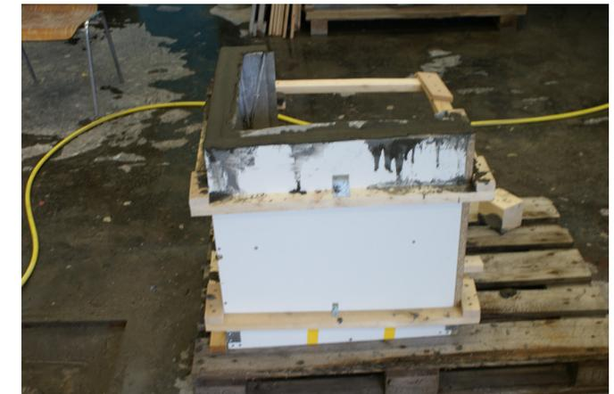
Abb.147 fertig eingebrachter Beton
