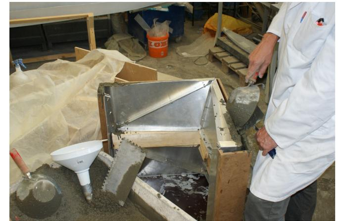
Abb.137 Betoneinbringung in die Schalung
