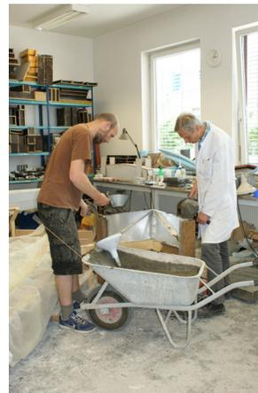
Abb.139 Betoneinbringung in die Schalung
