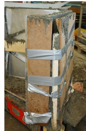
Abb.140 Stabilisierungsversuch der geplatzen Schalung
