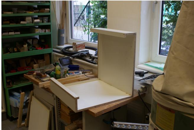
Abb.142 Holzschalung aus beschichteten Spanplatten
