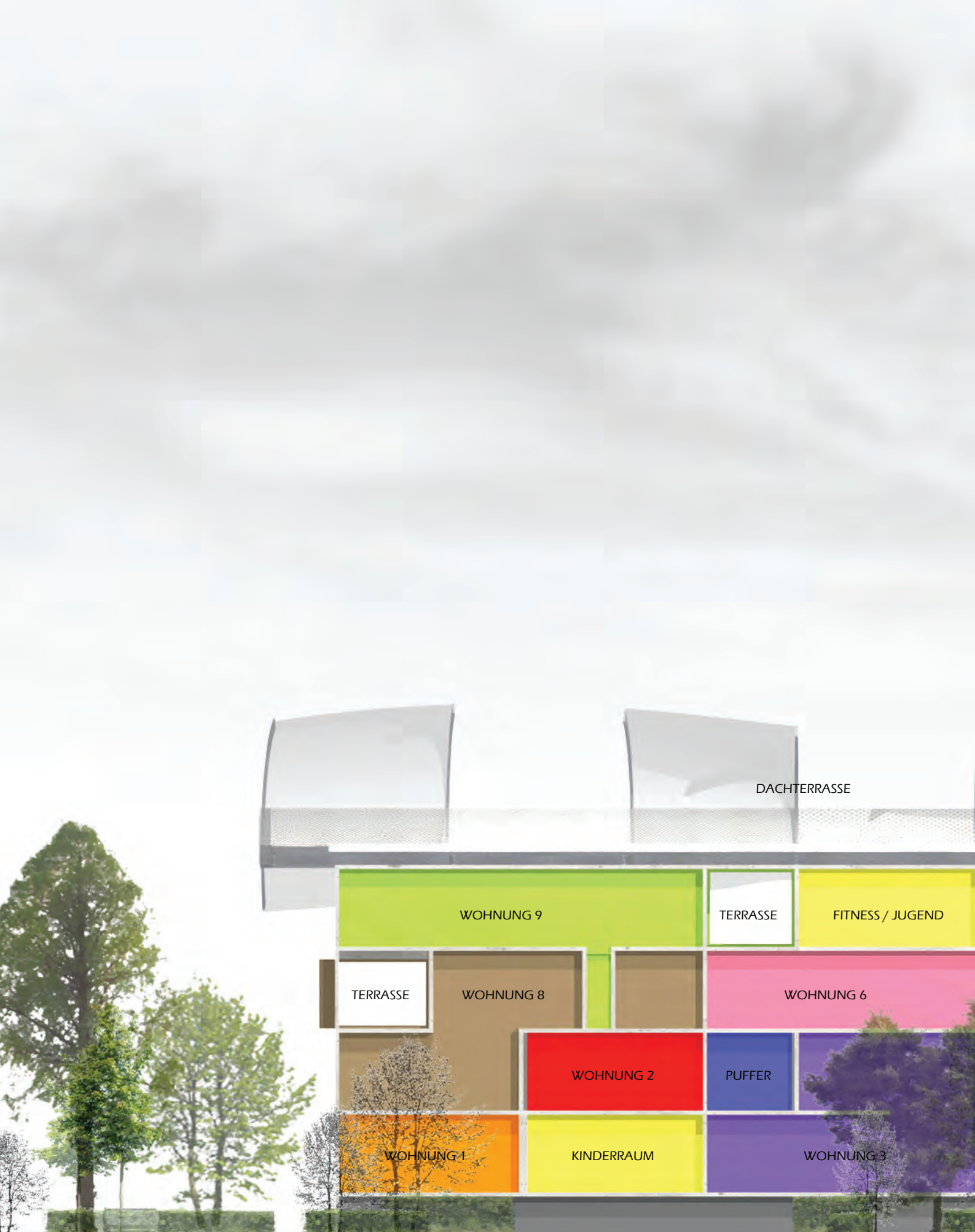
ABB.69 VISUALISIERUNG LÄNGSSCHNITT - Darstellung der verschachtelten Maisonette-Wohnungen. Dazwischen eingebettet befinden sich Terrassen, Puffer- und Gemeinschaftsräume
