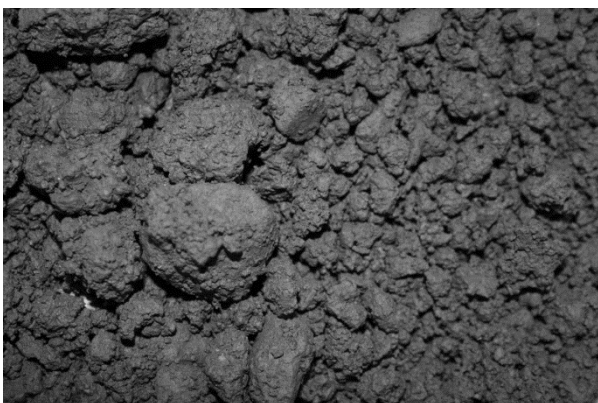
Abbildung 39: Lehm, eine Mischung von Ton, Schluff, Sand und Kies
