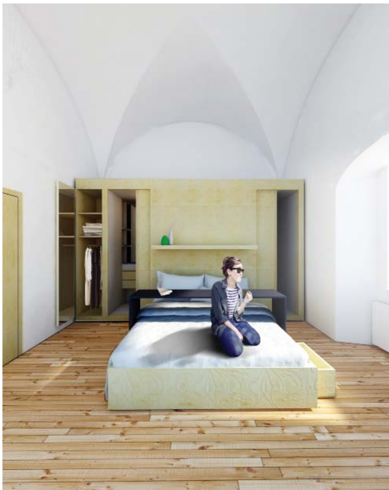
Abb_237: Ansicht eines neuen Doppelzimmers mit Schlaf-/ Sanitärmodul und Schrankerweiterung links. Durch die Schattenfuge setzt sich der Einbau klar vom Bestand ab. Der neue Dielenbelag ist ebenso durch ein schwarzes Fugenband vom Bestand getrennt. Der schiebbare Stahltisch kann als Tisch über dem Bett verwendet werden, oder als Ablage an die Rückwand des Zimmers gestellt werden.
