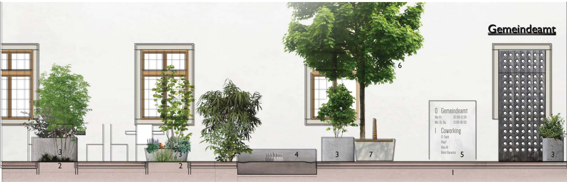
Abb_233: Freiraumkonzept; 1 Sandgeschlämte Decke, 2 Naschhecken Flachstahl gefasst, 3 Scherm mit Bewuchs, 4 Outdoorkegelbahn, 5 Stele mit Raumbelegung, 6 neuer Baumbewuchs, 7 Bank Granit mit Holzauflage und Lehne,
