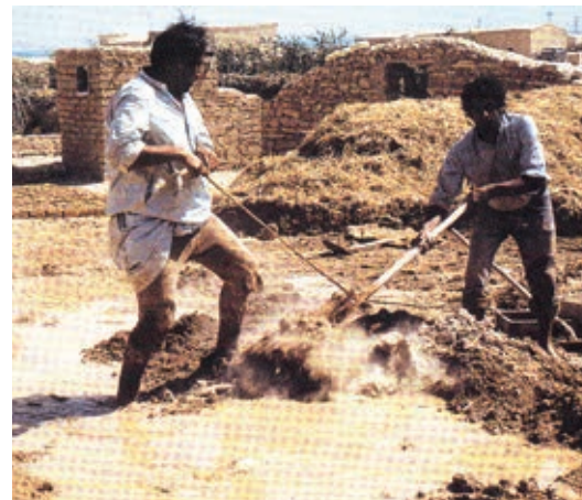
Abb. 54: In einer Lehmgrube wird ein Lehmgemisch für die Herstellung von Lehmziegeln produziert.
