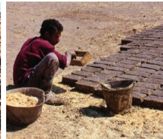
Abb. 55: Formung von Lehmziegeln mittels einer rechteckigen Holzschalung.
