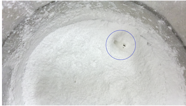
Abbildung 5.38: Foto der Reaktorinnenkammer nach Versuchsdurchführung. Gebildete Kanäle sind blau eingekreist.
