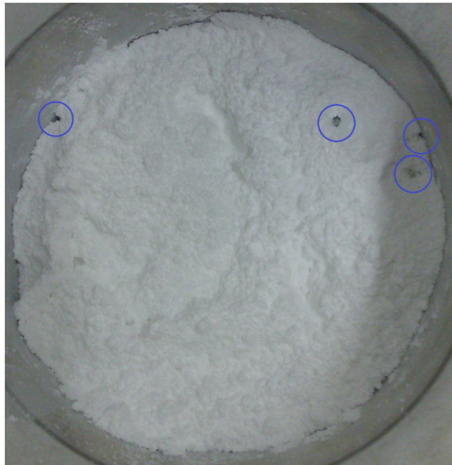
Abbildung 5.37: Foto der Reaktorinnenkammer nach Versuchsdurchführung. Gebildete Kanäle sind blau eingekreist.
