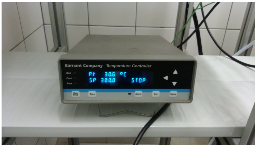
Abbildung 3.5: Temperaturregulierende Station von Barnant Company zur Vermeidung der Überhitzung des kleinen Durchflusserhitzers.
