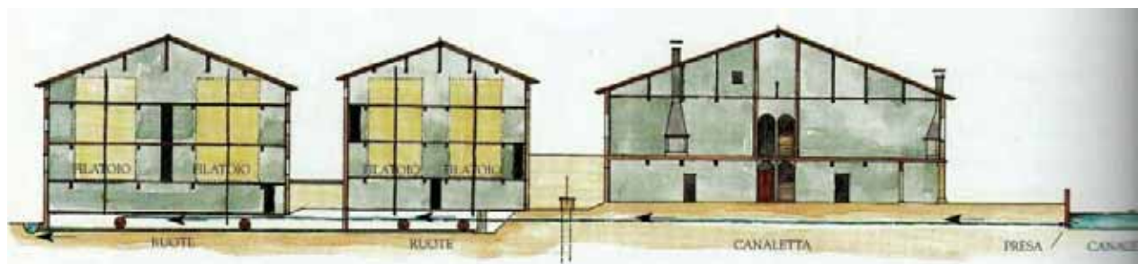
Bild 4. 115 Schematischer Schnitt, Haus und Spinnereien, Zuflüsse vom Kanal, Räder, Abfluss
