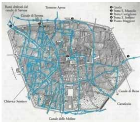
Bild 4. 84 Fließrichtung der Wasserpfade und Abwässer 1662-63, Abflußkanäle
