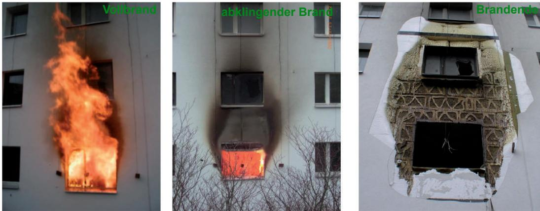
Vertikale Brandausbreitung über Ventilationsöffnung ab der Vollbrandphase nach Kotthoff. Abb.3.21
