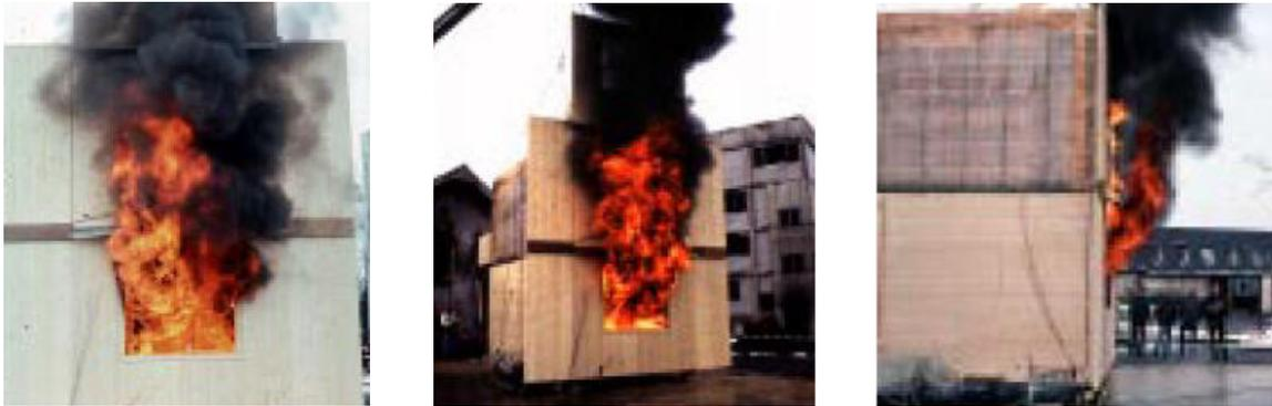
Hotelzimmerbrand im Naturbrandversuch „BÜ demo“ mit nichtbrennbarer Innenverkleidung. Abb.3.8
