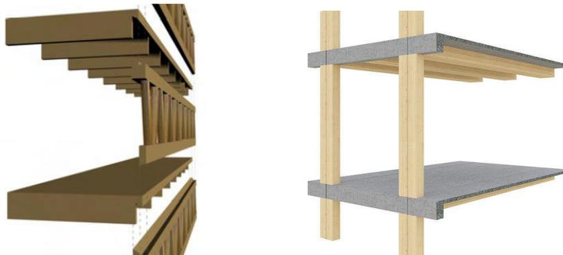
Links: aus den Forschungsergebnissen des Projektes „Achtplus“ die Elementierung von Fassade und Decke, Rechts: die Elementierung der Fassade und der Decke des LCT 1. Abb.5.30
