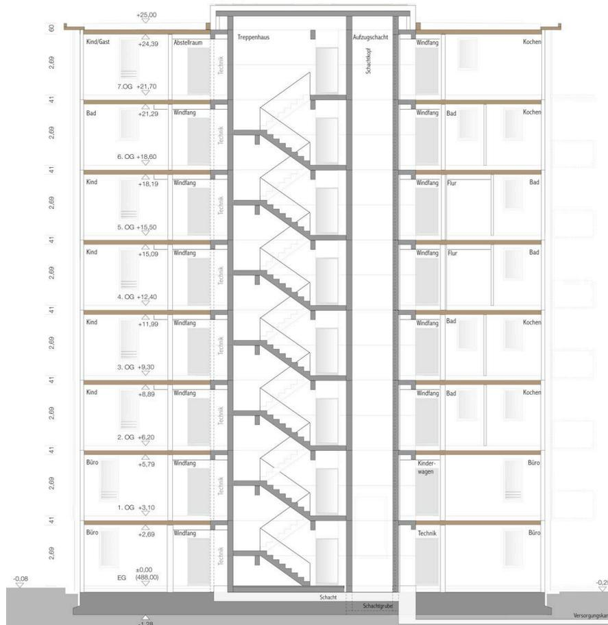
Schnitt durch das Gebäude und Fluchtstiegenhaus aus Beton- Fertigteilen. Abb.5.13
