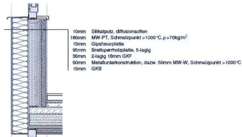
Feuerwiderstand REI mit einer Feuerwiderstandsdauer von über 90 Minuten und einem Schutz vor dem Entzünden der brennbaren Konstruktion von 90 Minuten nach gutachterliche Stellungnahme im Einzelfall von Pöhn (2010). Abb.6.1
