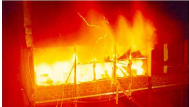
Aufstellen der Holzkippen mit  $40 \text{ kg/m}^2$  im Brandraum und Abbrand der Brandlast (rechts). Abb.3.16
