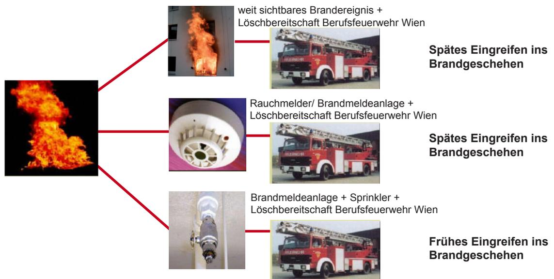
Beeinflussung des Naturbrandverlaufes durch Löschmaßnahmen. Abb.3.24
