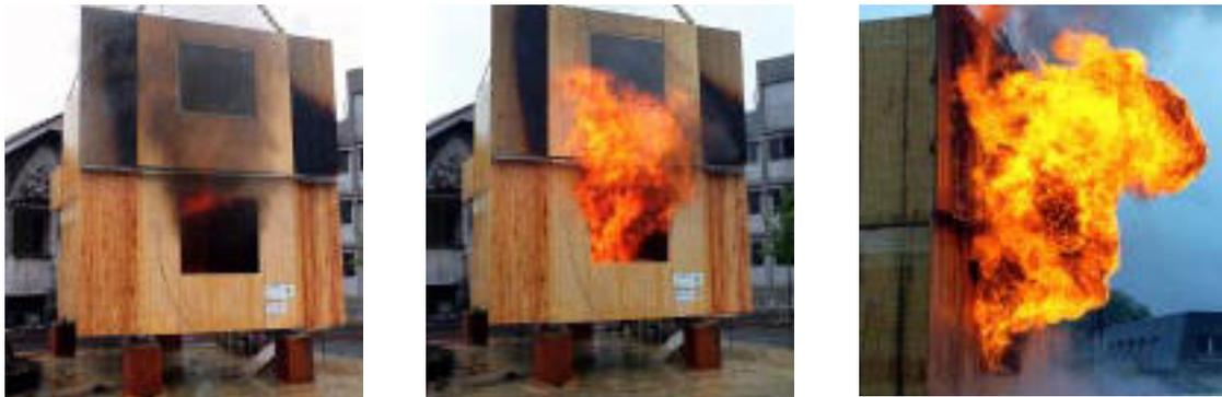
Hotelzimmer im Naturbrandversuch „BÜ bb“ mit brennbarer Innenverkleidung. Abb.3.10
