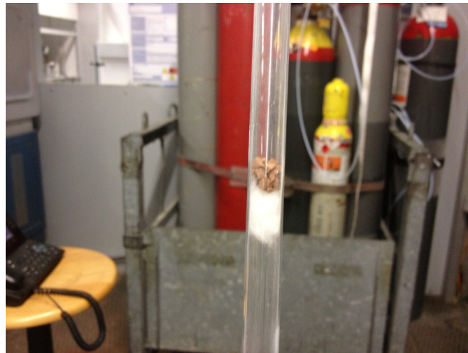
Abbildung 5.2: Vorbereiteter Quarzglasreaktor, unten: Quarzglaswolle (weiß), oben: gepresste Asche-Stücke.
