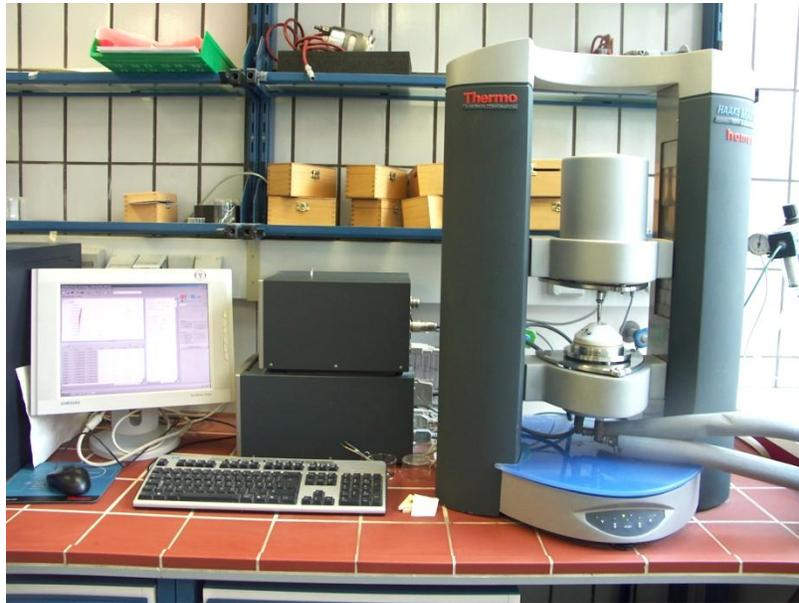
**Abb. 3-3 Dynamisches Scherrheometer**
