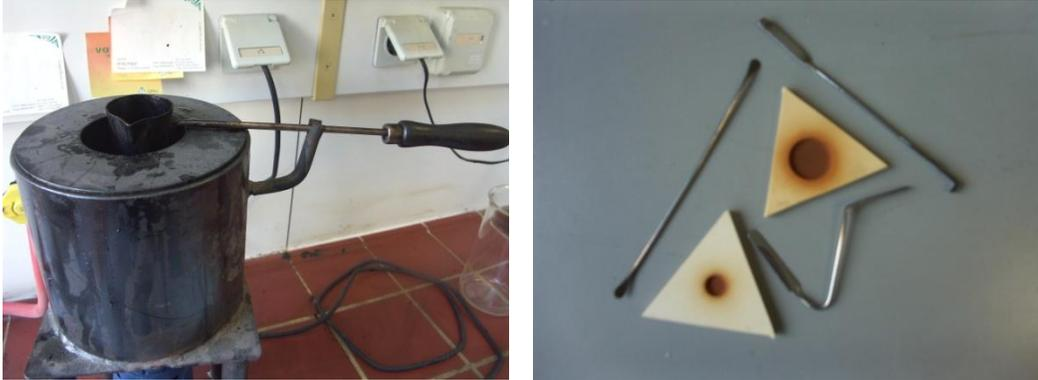
**Abb. 3-8 Erhitzung und Homogenisieren des Bitumens, Gussformen und Spateln**
