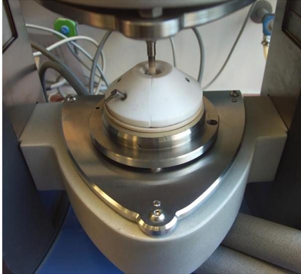
**Abb. 3-10 Weiße Gummiabdeckung der Prüfprobe**
