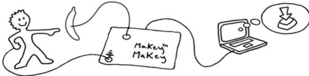
ABBILDUNG 7 – FUNKTIONSWEISE MAKEY MAKEY, QUELLE:
