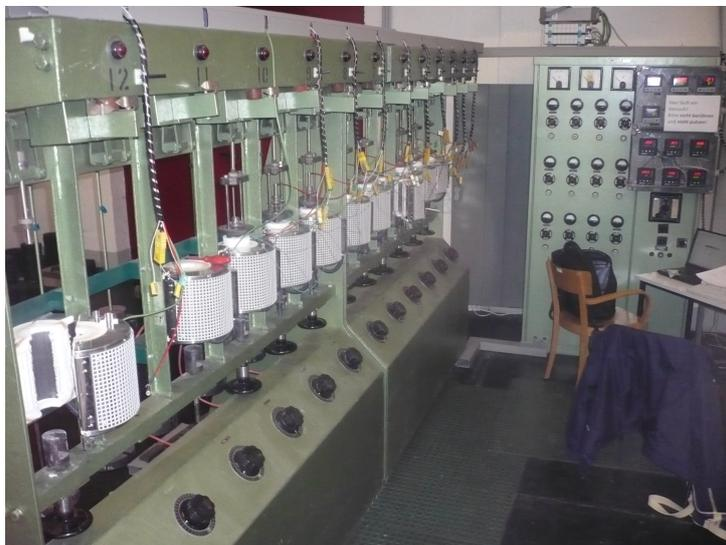
Abbildung 4.4: Kriechmaschine Vorderansicht [31]
