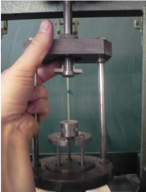
(a) Einführung der Zugvorrichtung [31]
