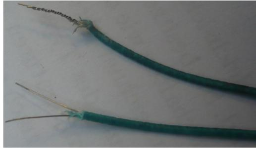
(a) Thermoelemente Typ K abisoliert und verdrillt [31]
