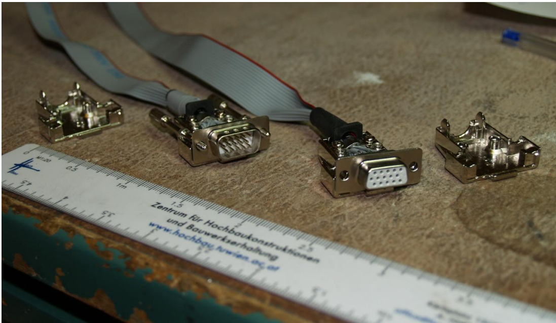
Abbildung 7.26: Verbindungskabel mit geöffneten Steckern: links der männliche und rechts der weibliche Teil
