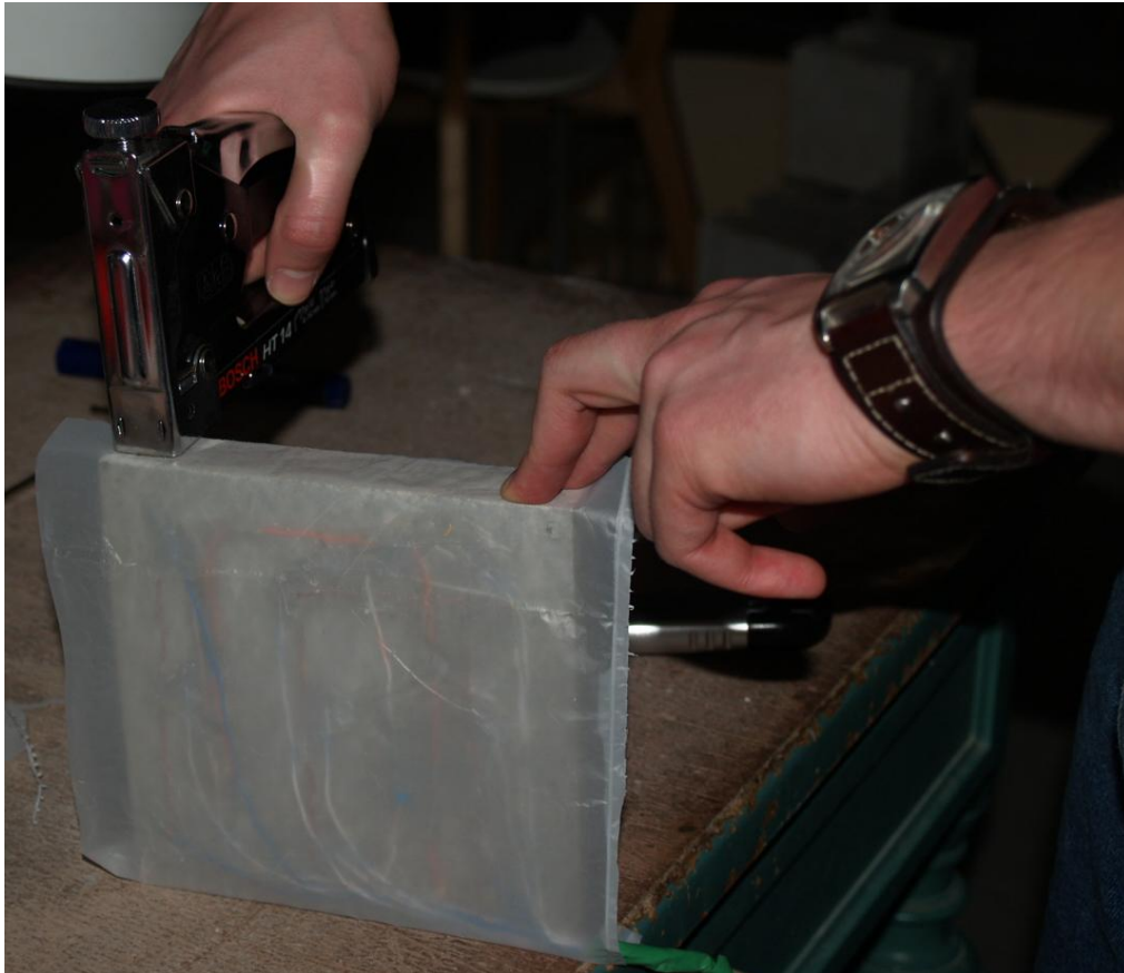
Abbildung 7.29: Anbringen der Schutzfolie an die Probenplättchen
