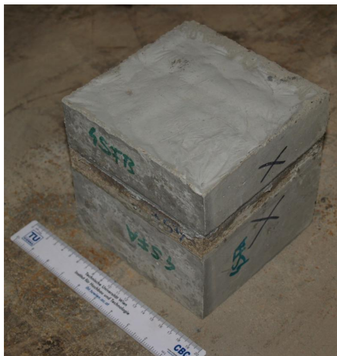
Abbildung 7.42: Probe 4SF mit um 180° gedrehtem Probenteil B und den Markierungen für die späteren Marmorprismen: „X“
