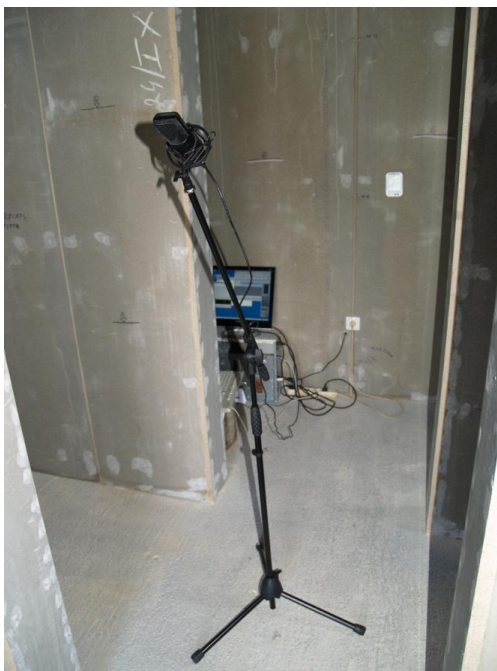
Abbildung 6.9: Im Testhaus plaziertes Mikrofon
