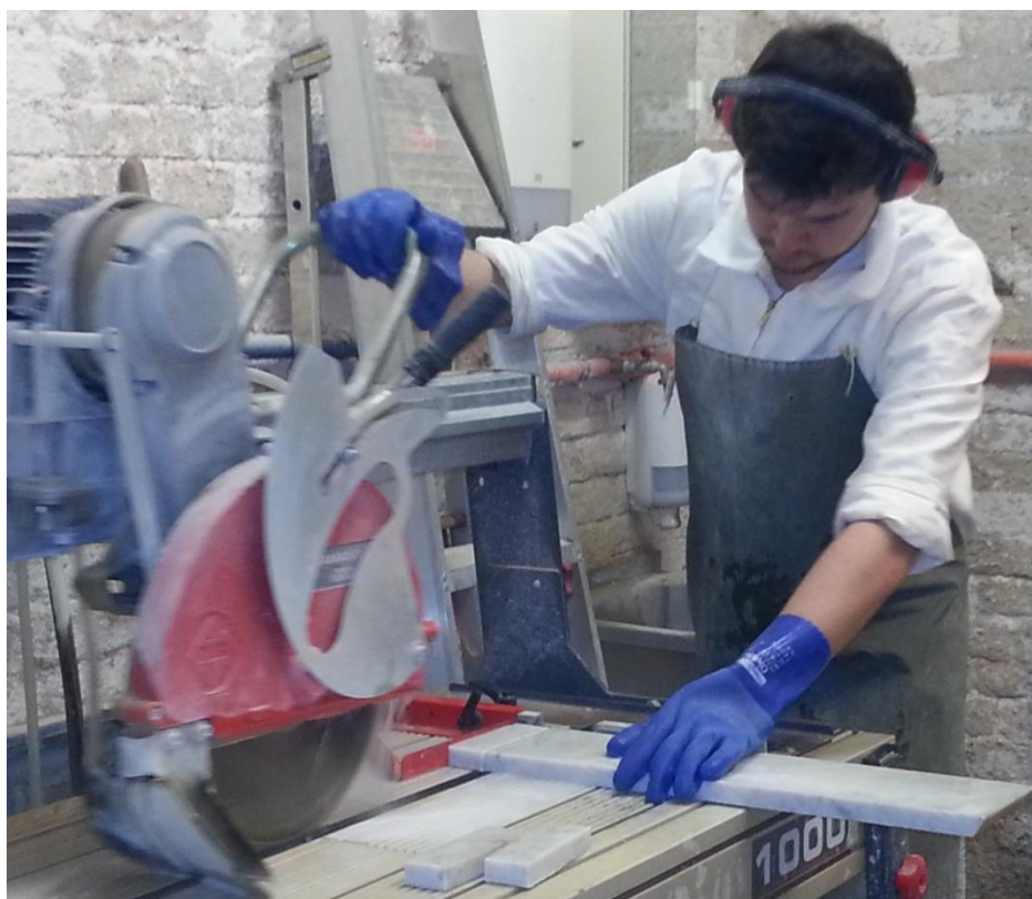
Abbildung 7.34: Schneiden der Marmorprismen
