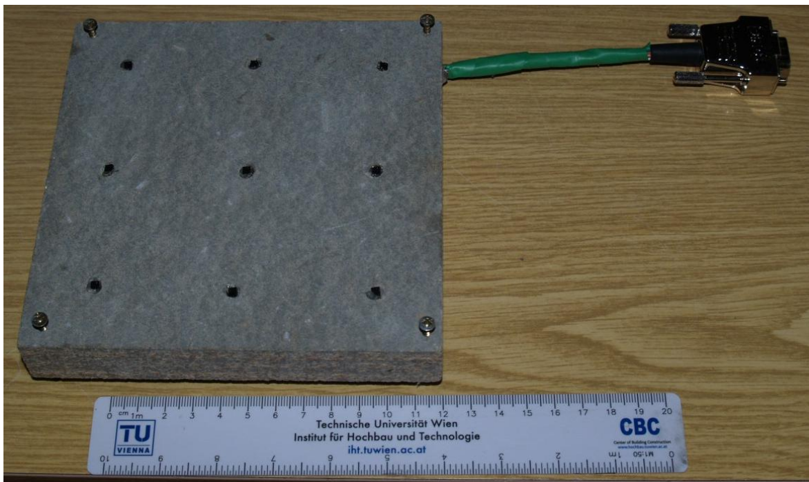
Abbildung 7.24: die Vorderseite inklusive Sensoren einer fertiggestellten Platte
