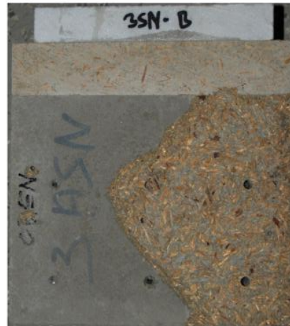
Abbildung 7.56: Vergleich des Farbspektrums des Feuchtigkeitsgehaltes der Proben 1SN bis 3SN mit deren Bruchbild
