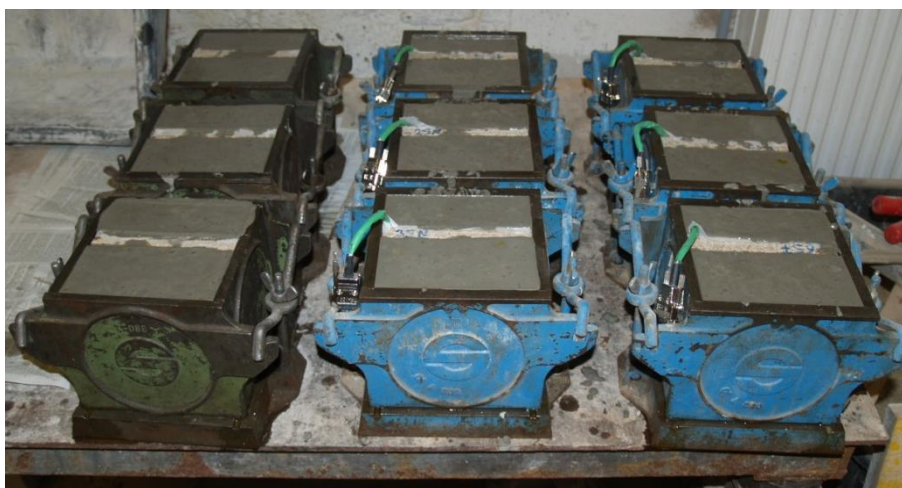
Abbildung 7.33: Stahlwürfelschalungen vor (oben) und nach (unten) dem Betoniervorgang
