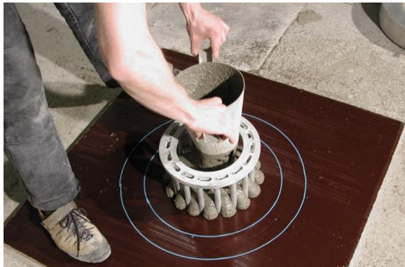
Abbildung 4.1: Überprüfung der Fließfähigkeit mit Blockierring [2]
