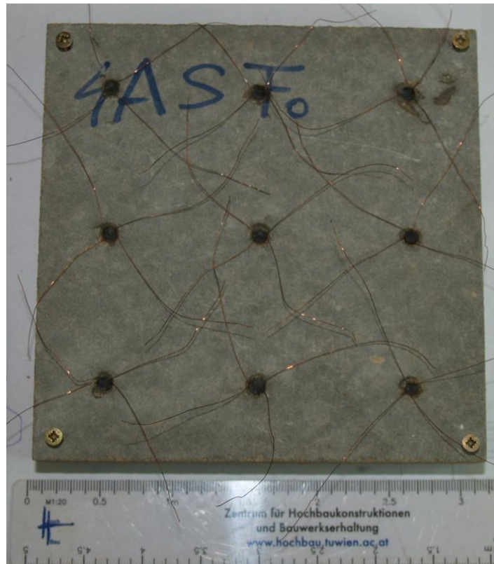
Abbildung 7.21: Rückseite einer Platte mit eingesetzten Chips
