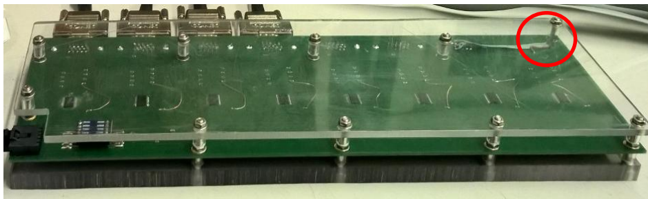
Abbildung 7.12: Der fertige Multiplexer-Bus mit rot eingekreistem Sensor zur Messung der RH und der Raumtemperatur
