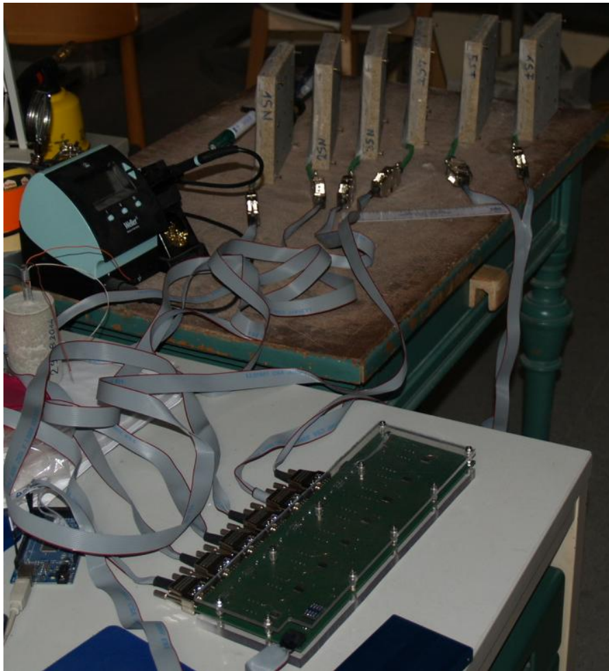
Abbildung 7.30: Der letzte Funktionstest des Zusammenspiels der folierten Platte, der Verbindungskabel, des Multiplexers, des Arduino-Boards sowie der Software
