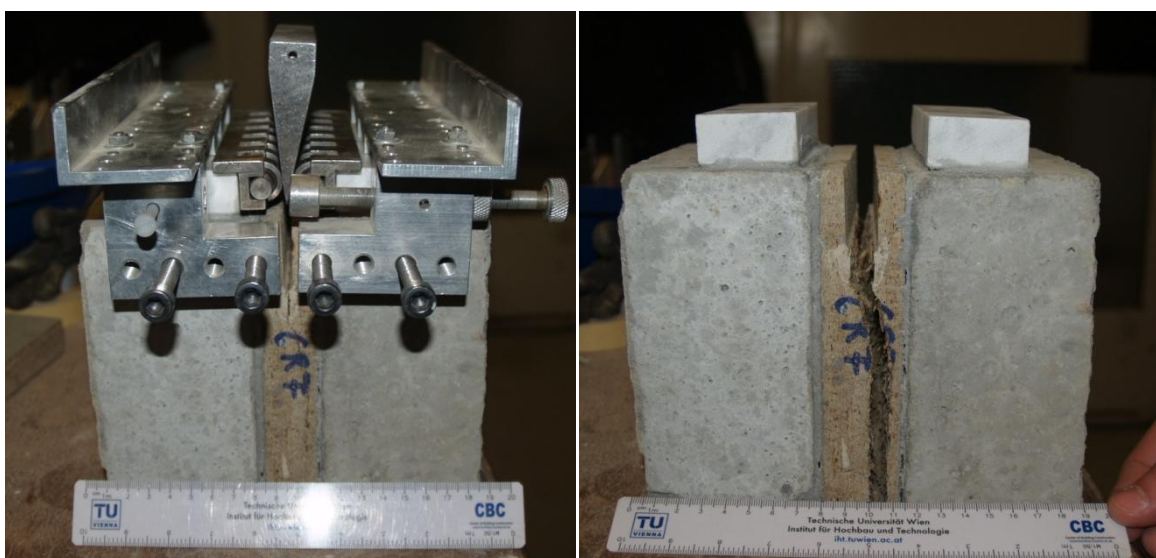
Abbildung 7.38: links: Probe 6RF mit Aluminiumrahmen, Walzlager und Keil rechts: Probe 6RF mit vollständig durchtrennter Platte
