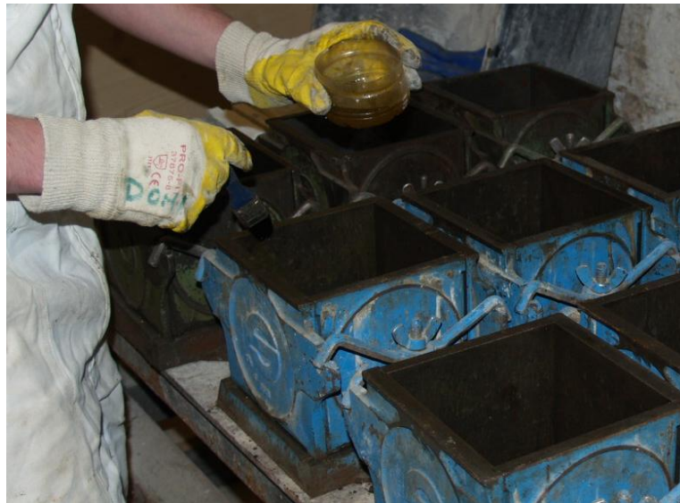
Abbildung 7.31: Einölen der Stahlwürfelschalungen
