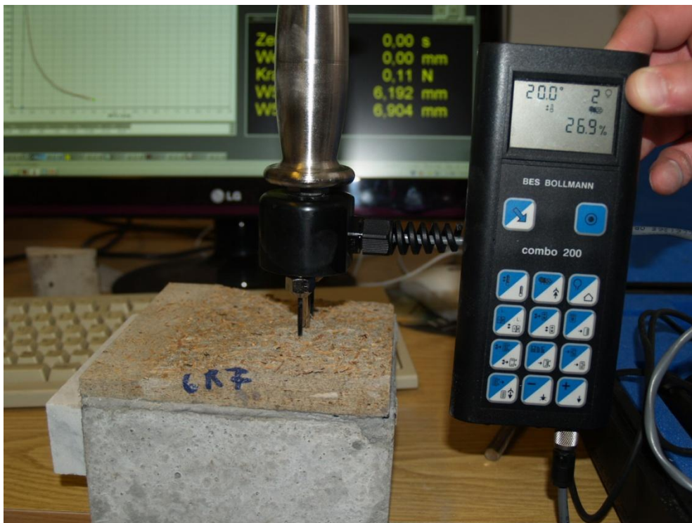
Abbildung 7.40: Feuchtemessung der Referenzplatten nach dem „Wedge-Splitting-Test“
