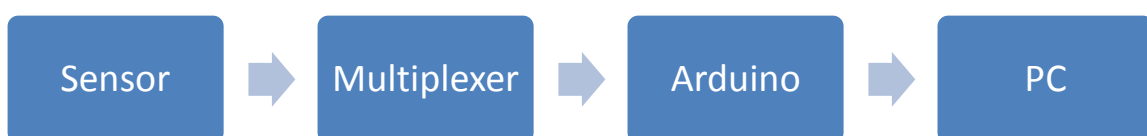
Abbildung 7.2: Hauptkomponenten für die digitale Messung der relativen Feuchtigkeit und der Temperatur
