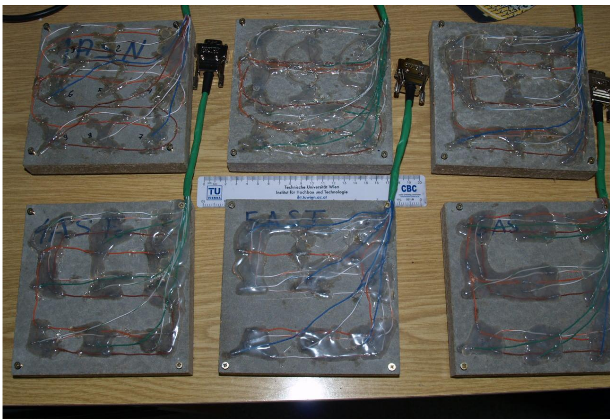
Abbildung 7.25: Die Rückseiten mit Verkabelung und Abdichtung aller fertiggestellten Platten
