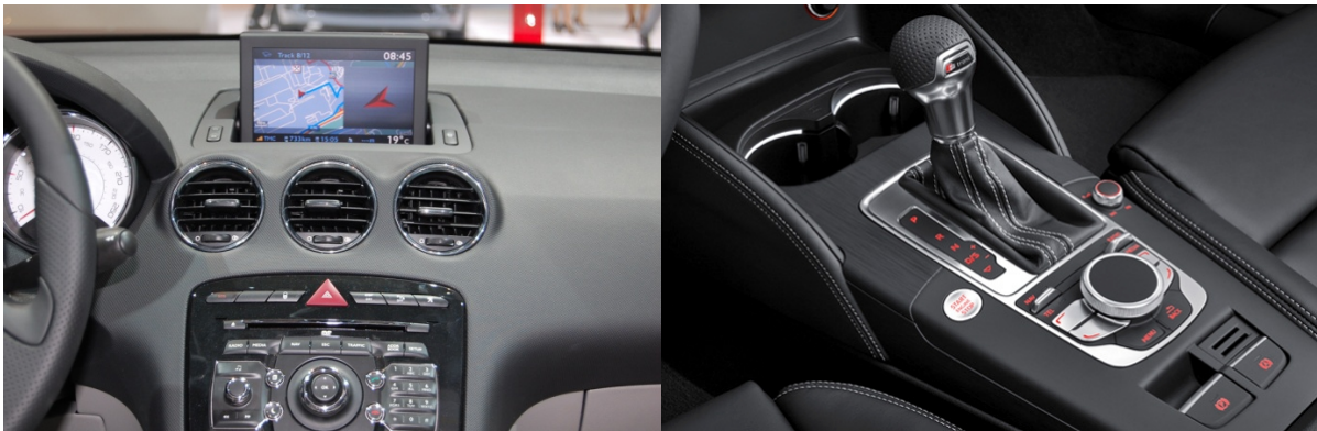
Abbildung 13: Interaktionselemente im Fahrzeug li.: Dreh-Drück-Steller und Taster nahe der Anzeige (Peugeot 308 CC1,6 THP - 2007) 104 re.: Dreh-Drück-Steller und Taster im unteren Bereich der Mittelkonsole (Audi A3 - 2012) 105
