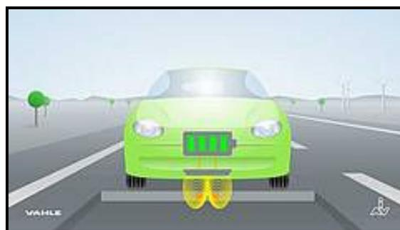
Abbildung 5-11: Funktionsprinzip für dynamisches induktives Laden [siehe Internetquelle 43]
