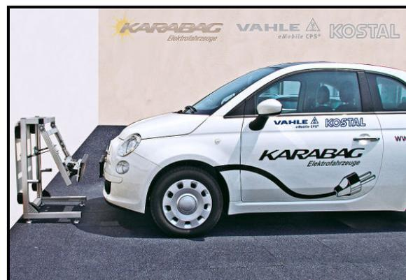
Abbildung 5-15: Primärspule hinter dem Nummernschild (VAHLE/Kostal) [siehe Internetquelle 47]
