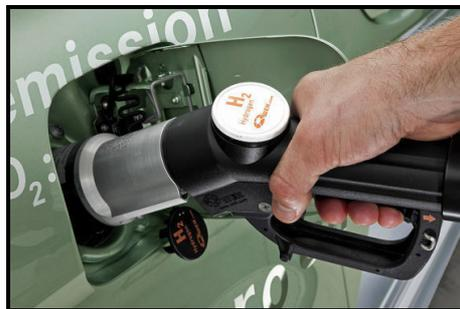
Abbildung 5-18: Tankstutzen für gasförmigen Wasserstoff [siehe Internetquelle 51]
