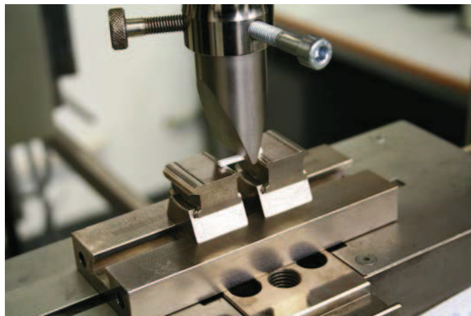
Abb. 3.11: Versuchsaufbau für 3-Punkt-Biegetest an Prüfstäbchen
