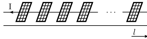
Abbildung 8.4.: Stromverteilung bei Serienschaltung der PV-Module
