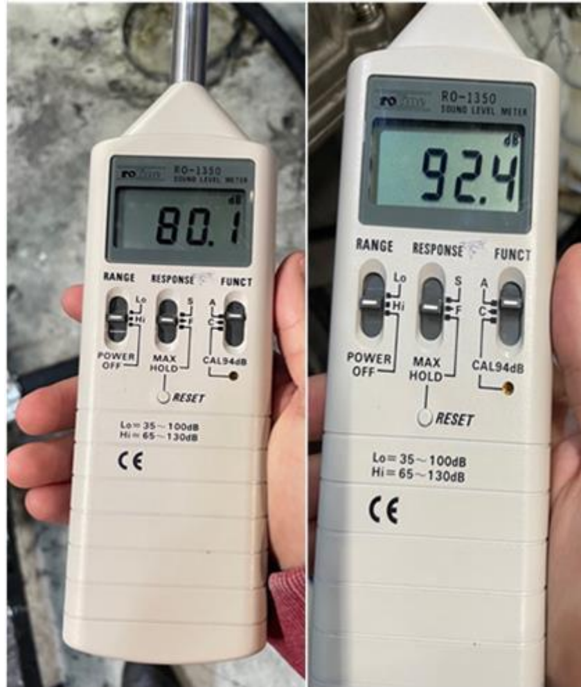
Abbildung 3-17 | links: Messung am Abfüllpunkt, rechts: Messung neben der Pumpe (Eigendarstellung)
