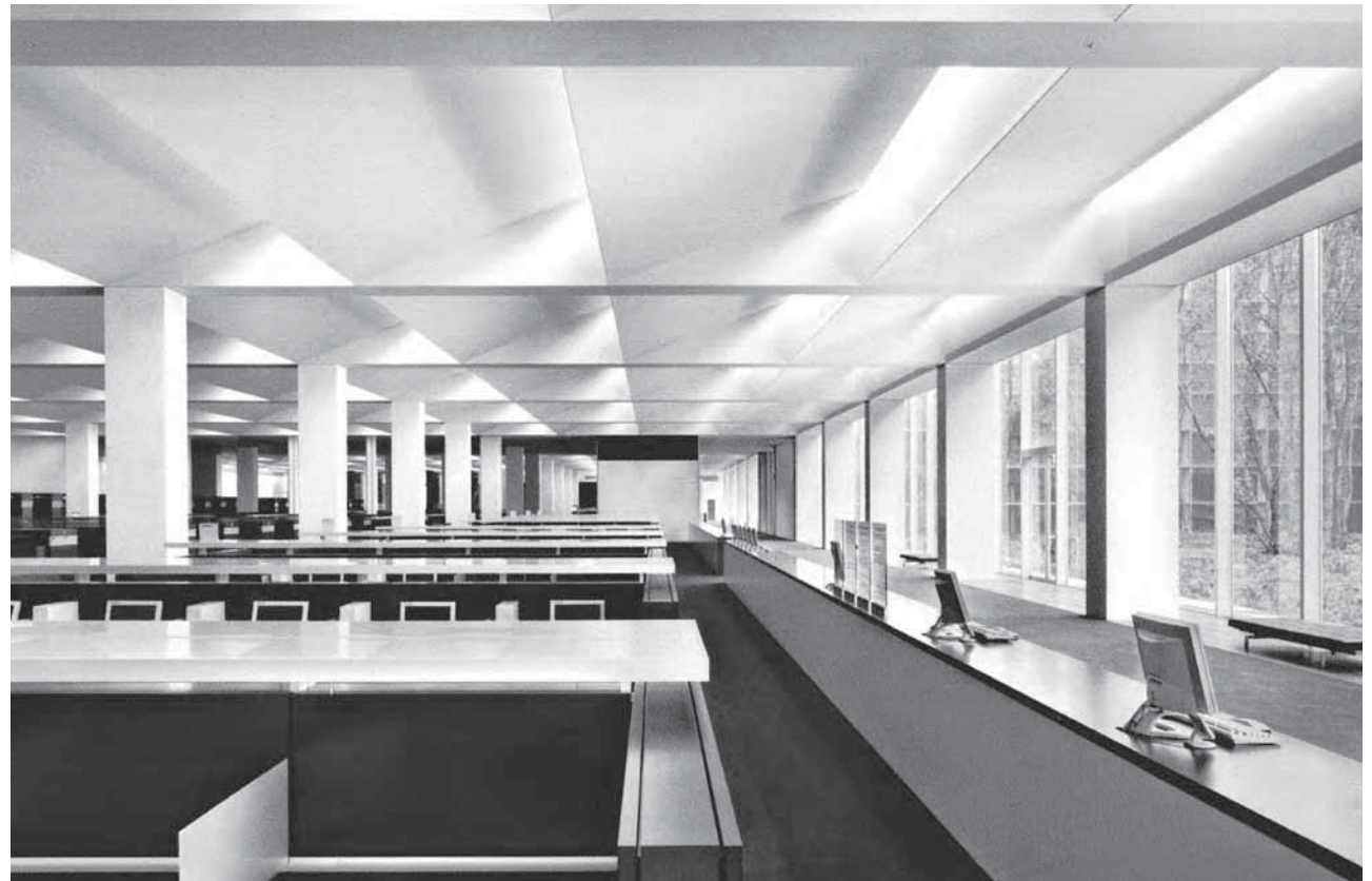
Abb. 3_26: Indirekte Beleuchtung durch Oberlichter in der Nationalbibliothek in Kansai
