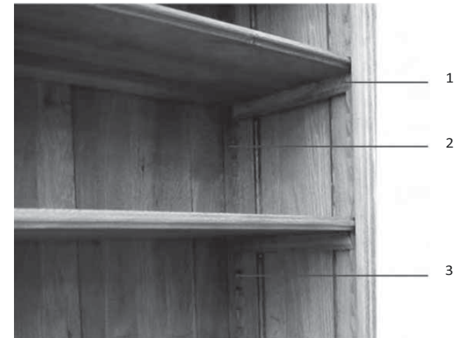
Abb. 4_08: Prinzip der Regal-Zahnleiste
