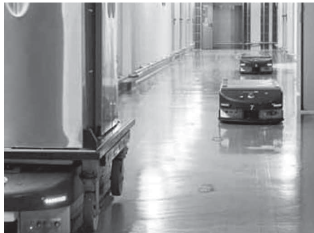
Abb. 3_20: Fahrerloses Transportsystem TransCar von Swisslog
