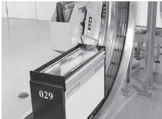
Abb. 3_19: Fördersystem Teleafth mit selbstfahrenden Behältern
