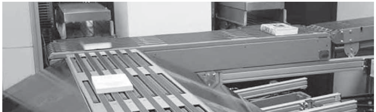
Abb. 3_22 Transportsystem mit automatischer Be- und Entladefunktion für Bücherannahme und -rückgabe
