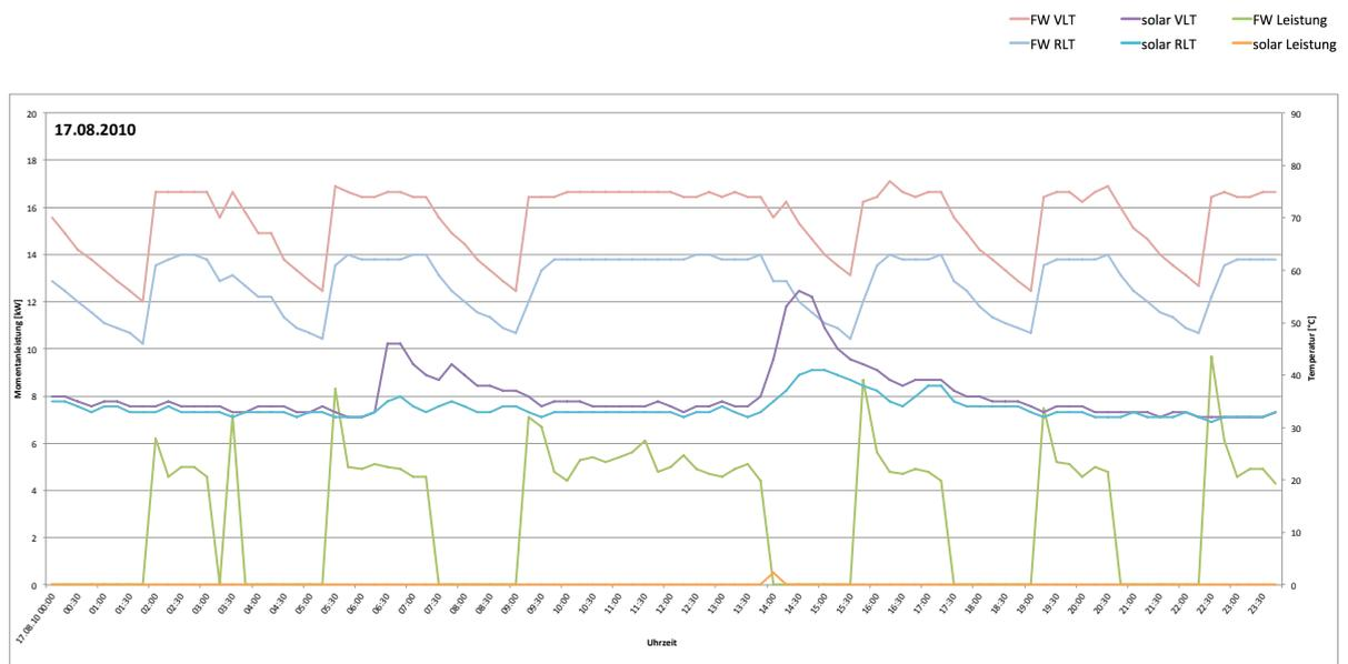
Abbildung 4.6.: Fernwärme- und solarseitiger Tagesverbrauch bei schlechtem Solarertrag (17.07.10)
