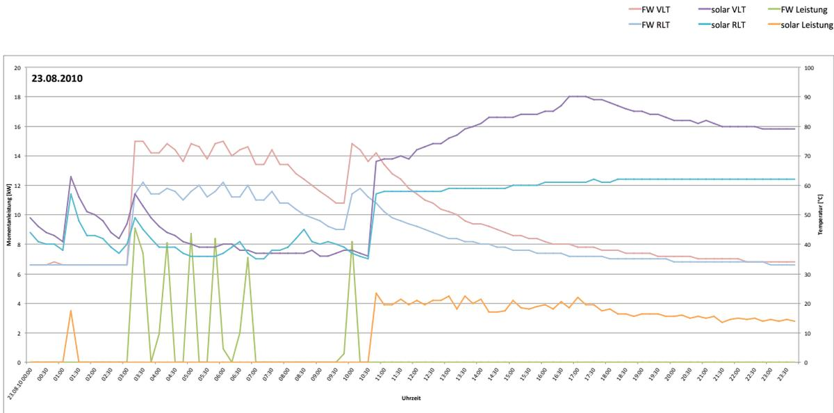
(a) Verbrauch bei gutem Solarertrag: Vorrangbetrieb (23.08.10)
