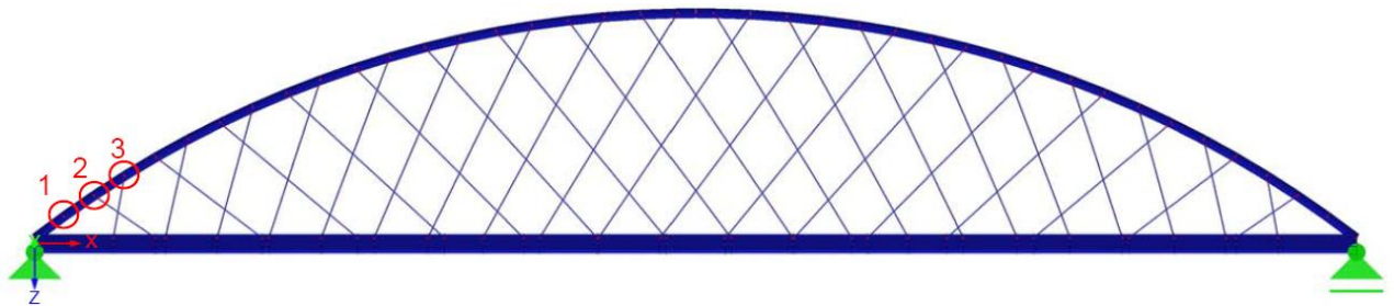
Abbildung 70 Netzgeometrie der konstanten Hängerneigungsänderung nach Modifikation der Netzgenerierung
