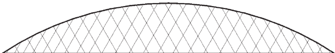
Abbildung 23 Weiterentwickelter Brückenentwurf mit konstanter Hängerneigung und konstanten Hängerabständen entlang des Bogens [3]
