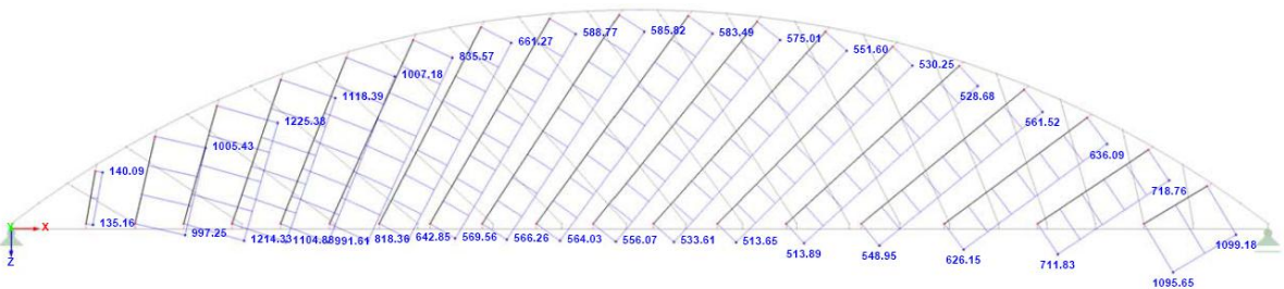
Abbildung 73 Normalkräfte in Hängerset 1 nach nichtlinearer Berechnung
