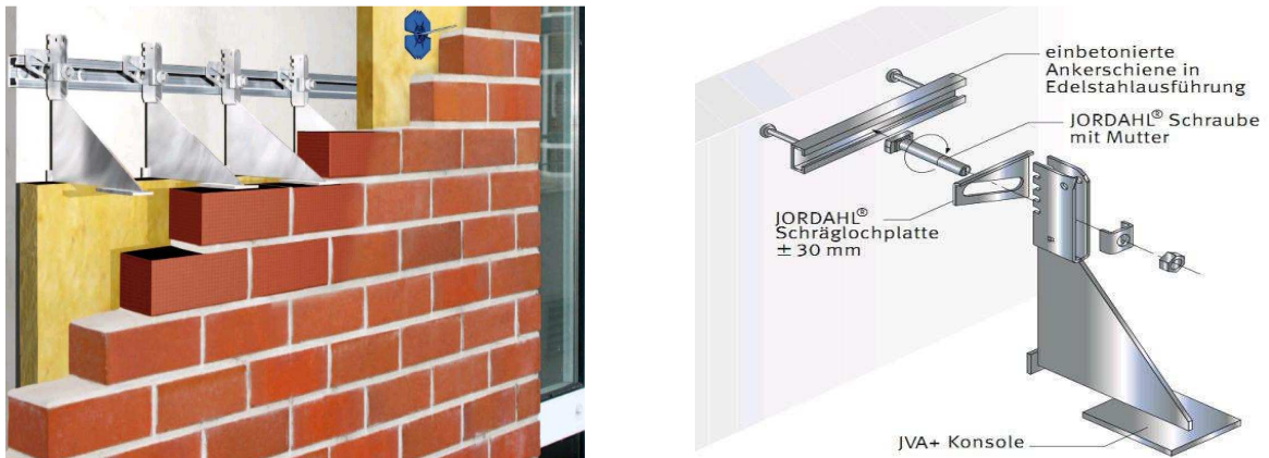
Abb. 4.3: Verblendmauerwerk (li.) nach [8] und Mauerkonsole (re.) aus [8]
