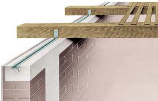
Abb. 4.11: Befestigung von Holzbalken mit Nagelanschlussanker (li.) und Balkenschuh an Stahlbetonwand (re.) mittels Ankerschiene aus [14] [12]
