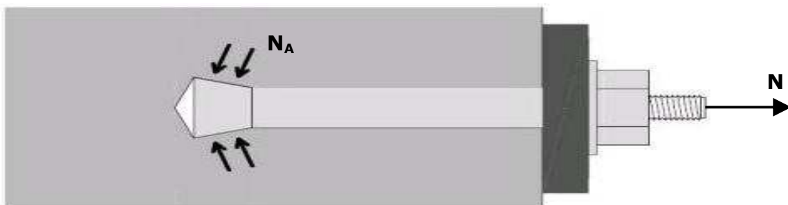
Abb. 3.2: Wirkungsweise einer Dübelverbindung mit Formschluss nach [36]
