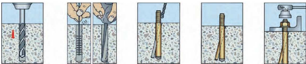
Abb. 3.30: Montage eines Hinterschnittdübels nach Abb. 3.22f nach [41]
