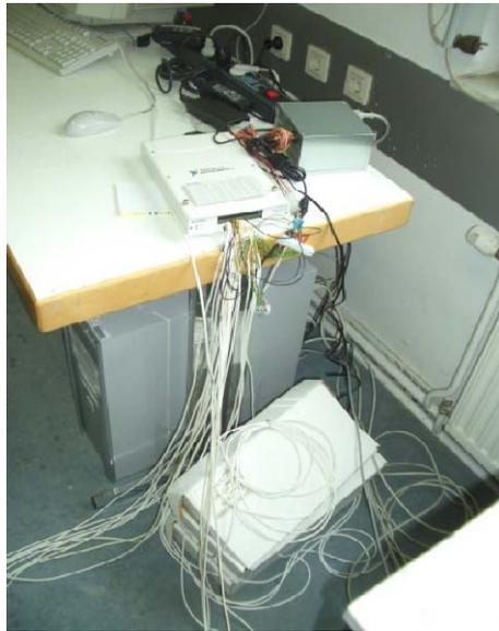
Abbildung 97: Datensammler für Temperatur und Feuchte Messungen
