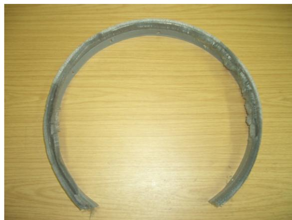
Abbildung 75: Dichtungsband für den Trommelumfang
