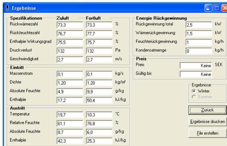
Abbildung 22: Ausgabeoberfläche Rotationswärmetauscher mit hygroskopischer Oberfläche
