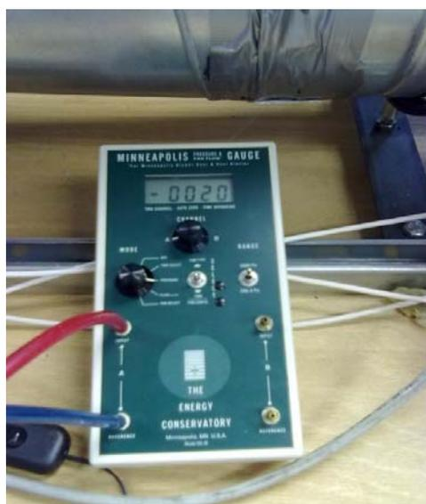
Abbildung 94: Messgerät zur Differenzdruckmessung
