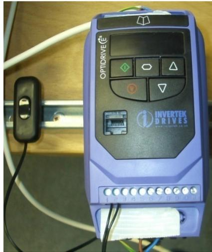
Abbildung 85: Frequenzwandler für Ventilatoren
