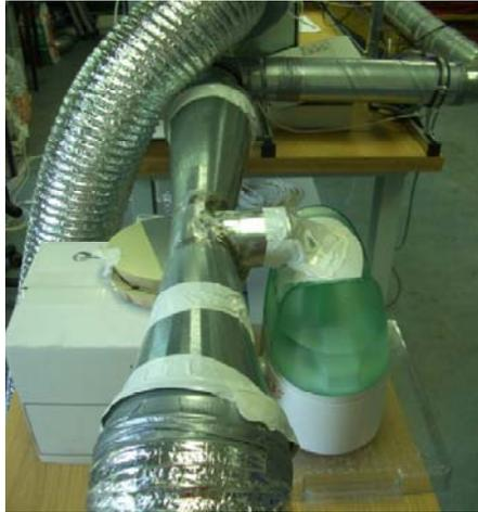
Abbildung 102: Anbindung des Luftbefeuchters an die Lüftungsanlage
