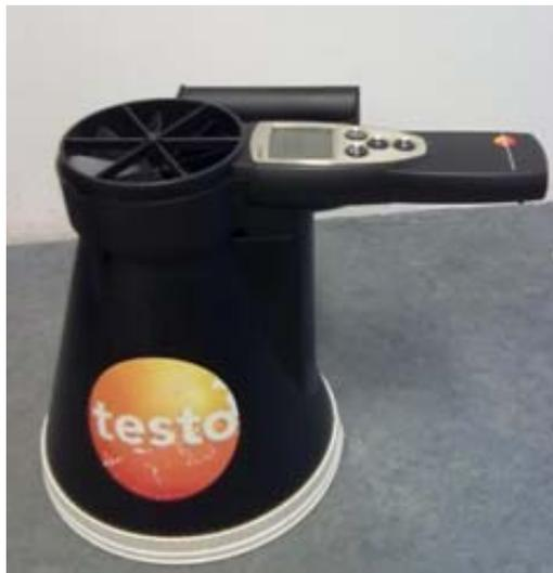
Abbildung 91: Luftgeschwindigkeitsmessgerät der Fa. Testo
