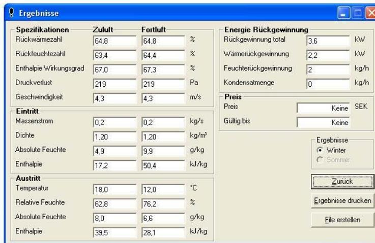
Abbildung 26: Ausgabeoberfläche Rotationswärmetauscher mit hygroskopischer Oberfläche
