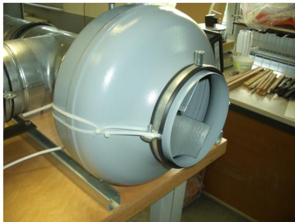
Abbildung 83: Radial-Rohrventilator K 160 T
