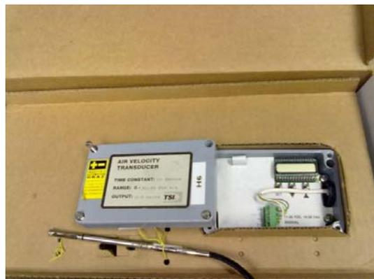
Abbildung 90: Luftgeschwindigkeitsmessgerät der Fa. TSI
