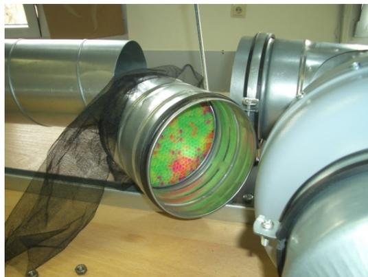
Abbildung 88: Selbstbau Strömungsgleichrichter
