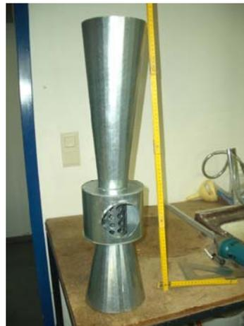
Abbildung 81: Venturi Düse in a.) konventioneller Bauart und b.) mit Spülkammer
