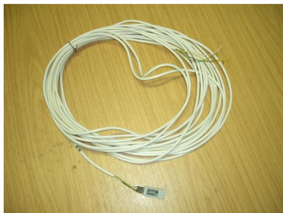
Abbildung 92: Messfühler zur Feuchte- und Temperaturmessung
