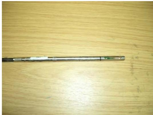
Abbildung 89: Messfühler für Luftgeschwindigkeitsmessung der Fa. TSI
