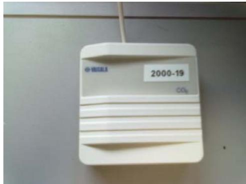
Abbildung 93: Messfühler zur CO<sub>2</sub> Messung
