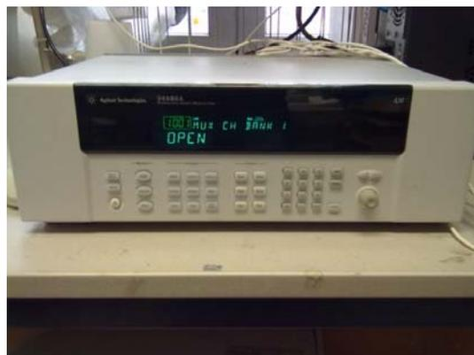
Abbildung 98: Datensammler für CO<sub>2</sub> Messungen
