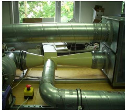
Abbildung 82: Venturi Düsen installiert a.) konventioneller Bauart und b.) Bauart mit Spülkammer
