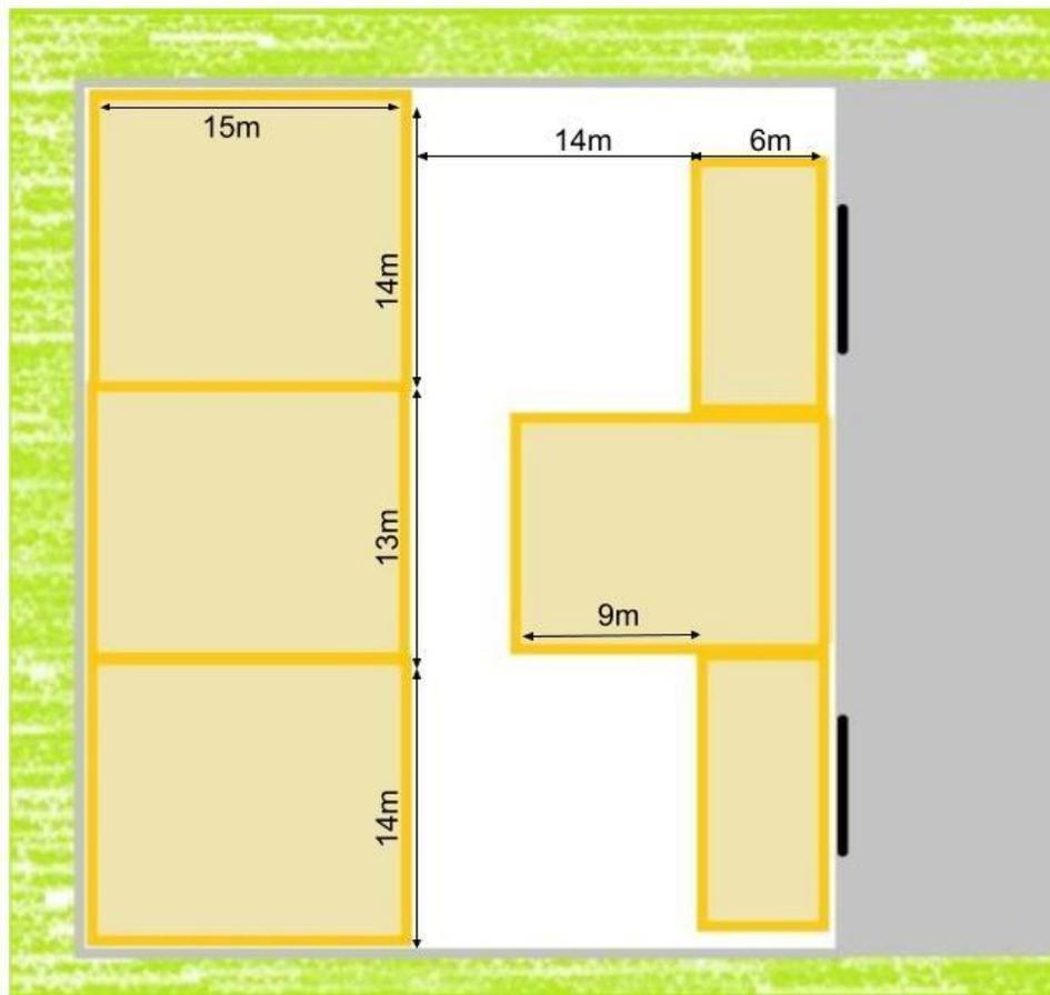
Abbildung 9: Layout der Fabrik mit wichtigsten Abmessungen, eigene Darstellung
