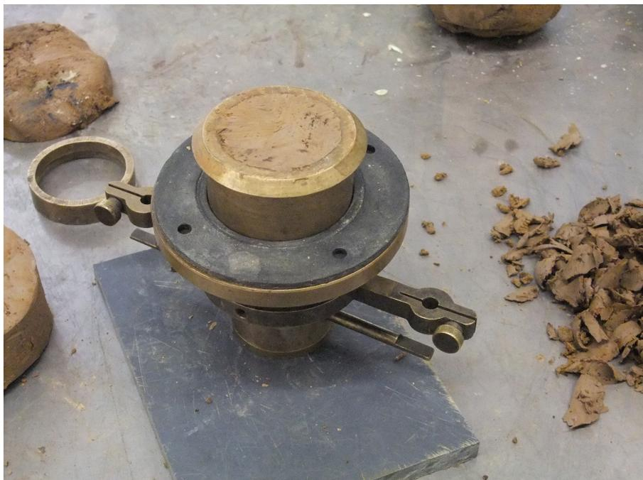
Abbildung A.4: Einbau der Bodenprobe in den Versuchsapparat.
