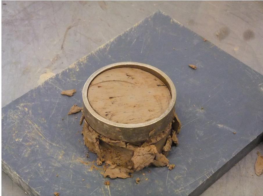
Abbildung A.3: Herausarbeiten des scheibenförmigen Probekörpers aus einer ungestörten Bodenprobe.
