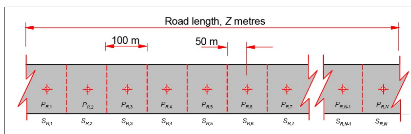
Abbildung 6.7: Betrachtete Strecke bei der akustischen Qualitätskontrolle von Fahrbahndeckschichten des EU-Projektes SILVIA [135]
