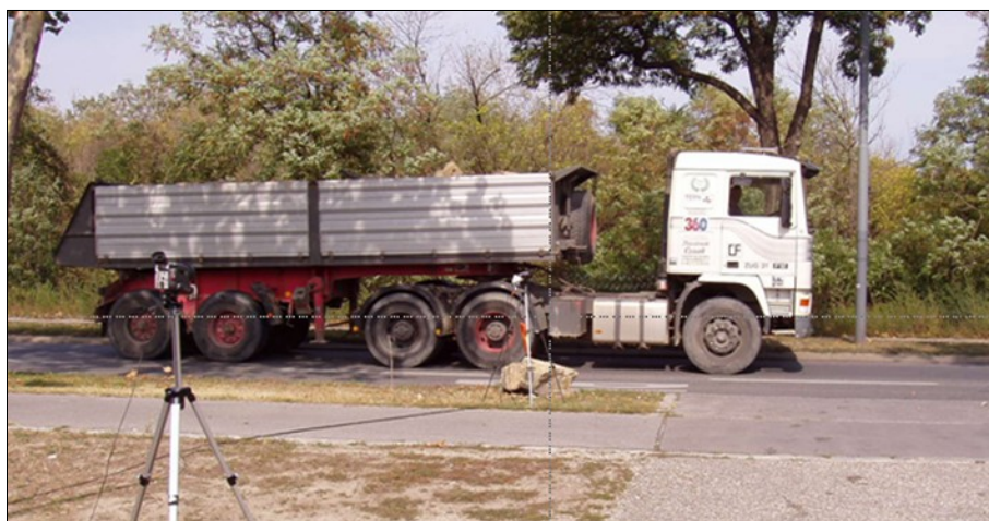
Abbildung 4.8: Beispiel für eine gültige Vorbeifahrtmessung gem. ISO 11819-1
