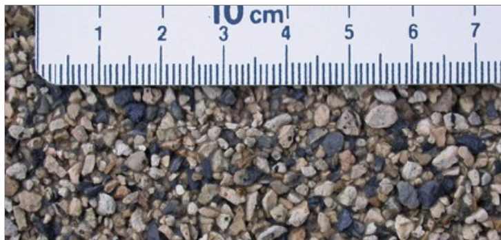
Abbildung 5.49: Beispiel für eine Oberflächenbehandlung auf Epoxidharzbasis (EP-GRIP) [133]
