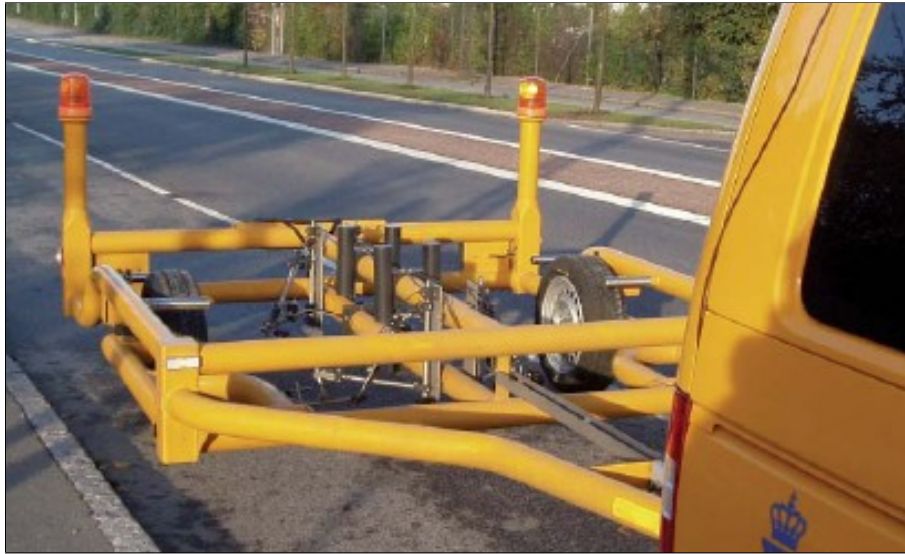
Abbildung 6.12: Rollgeräuschmessanhänger des Danish Road Institutes [151]
