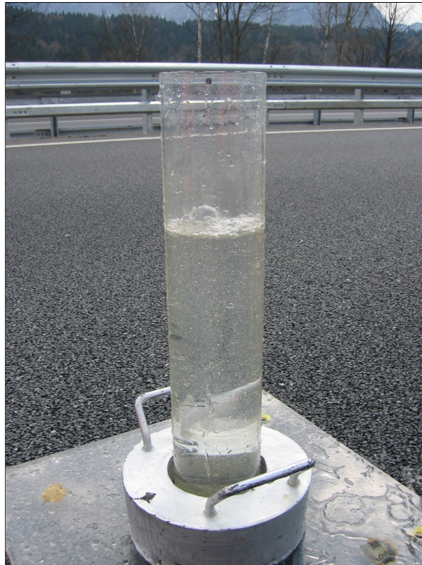
Abbildung 4.11: Messeinrichtung zur Bestimmung der Ausflusszeit
