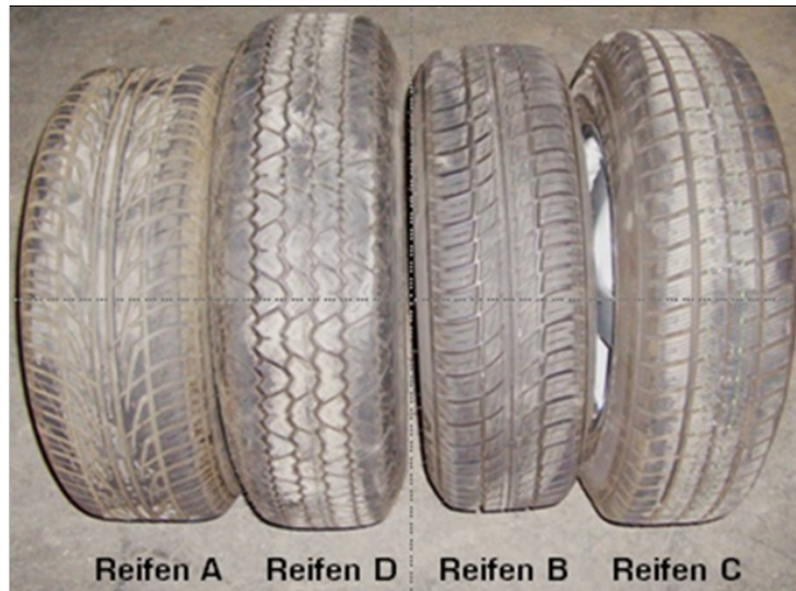
Abbildung 4.5: Beispiel der in Österreich verwendeten CPX-Testreifen (Photo: IFS Zivltechniker Ges.m.b.H)
