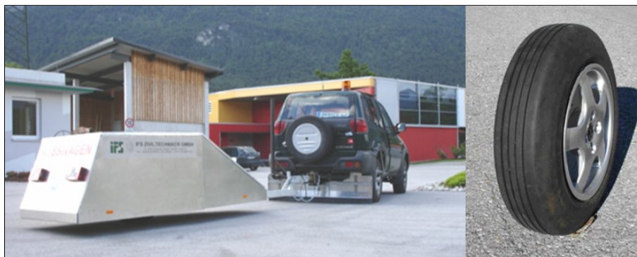
Abbildung 4.4: Beispiel eines österr. Rollgeräuschmessanhängers und Detail des zugehörigen Messreifens (Photos: IFS Ziviltechniker Ges.m.b.H)
