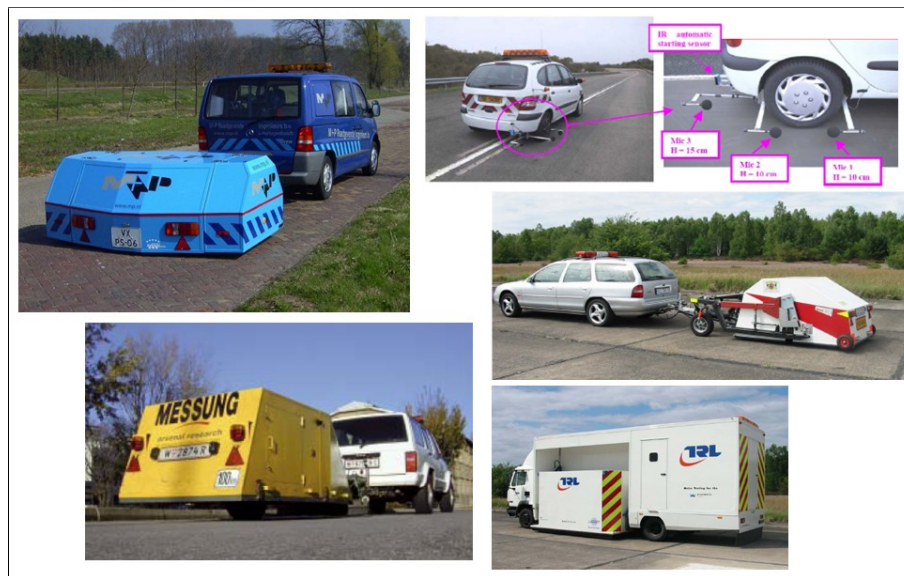
Abbildung 4.1: Unterschiedliche Messsysteme zur Bestimmung des Rollgeräuschpegels
