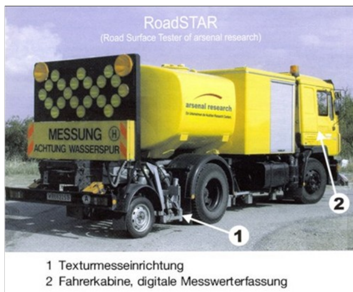
Abbildung 4.16: Messsystem RoadSTAR zur Messung der Oberflächentextur [79]
