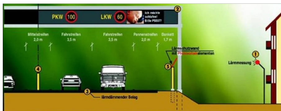
Abbildung 3.34: Schematische Darstellung der multifunktionellen Lärmschutzanlage in Gleisdorf [10]
