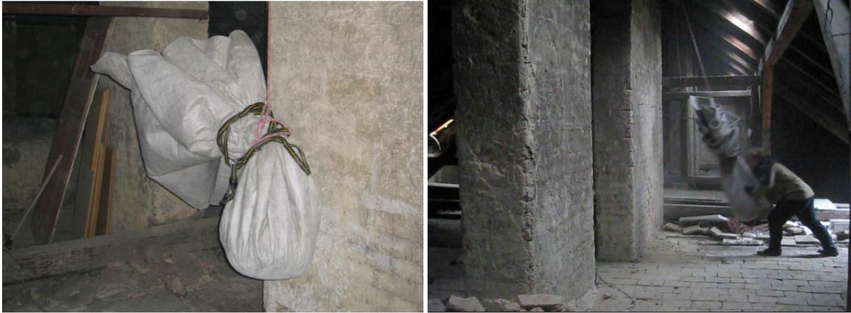
**Abbildung A 14:** Linke Abbildung: Punktmasse zur Aufbringung der impulsförmigen Belastung.
