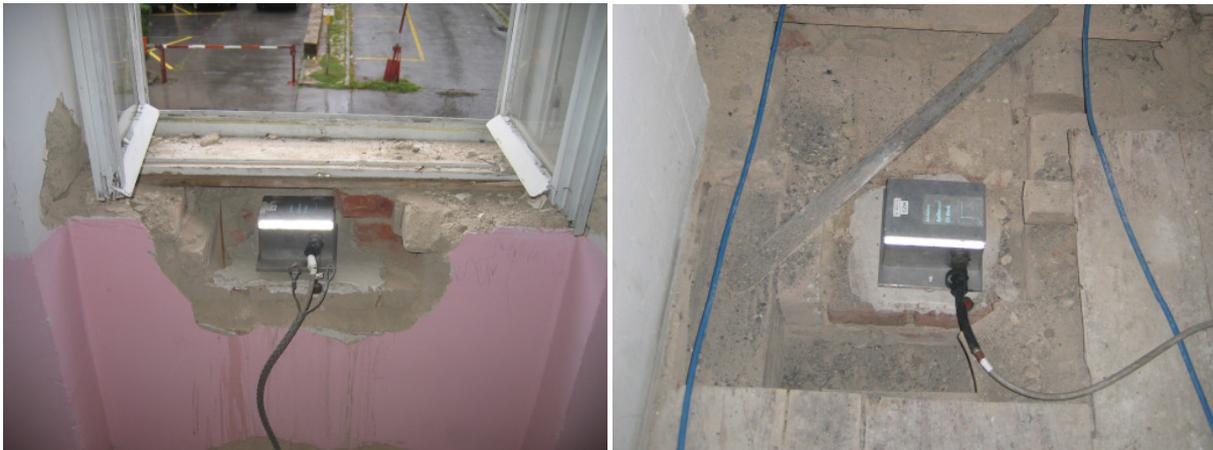
**Abbildung A 13:** Aufstellung der Beschleunigungsaufnehmer auf die vorbereiteten Positionen.
