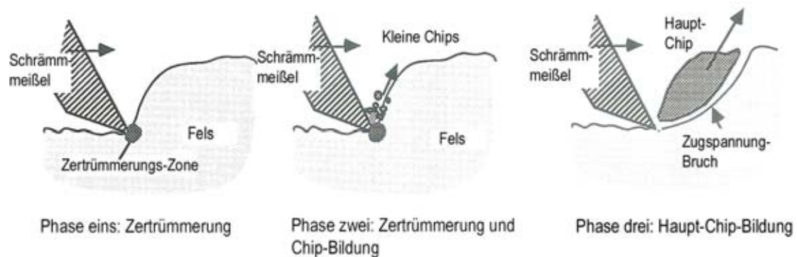
Abbildung 41: Phasen der Gesteinslösung durch einen Schrämmmeißel [19]
