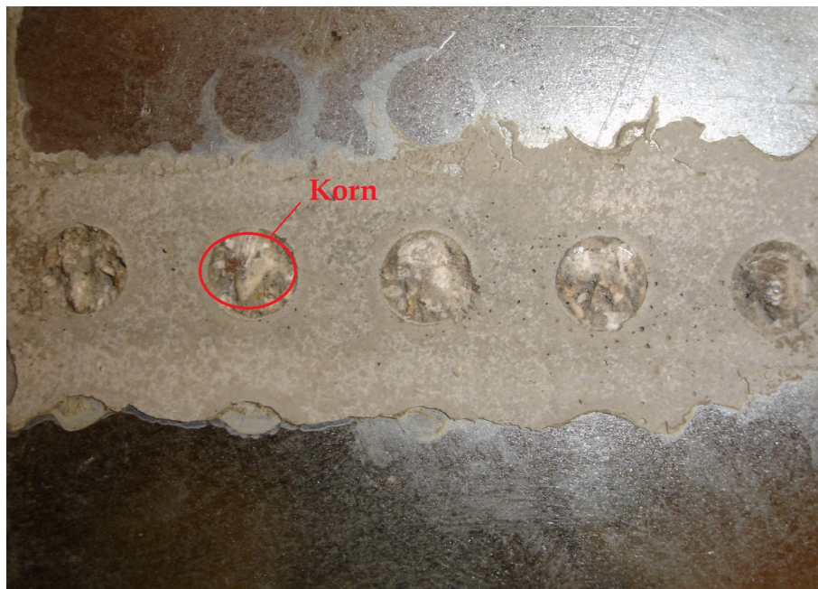
Abbildung 3.4: Gefüge in der Verbundfuge einer Dübelreihe, welche bis zum Versagen belastet wurde (VR-13A)
