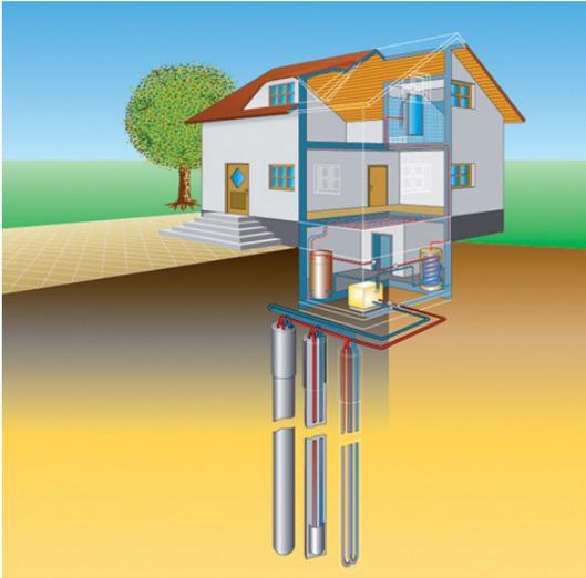
Abb. 1.40 | Erdwärmesonden
