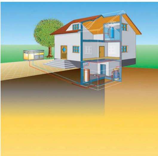
Abb. 1.44 | Wärmequelle Luft
