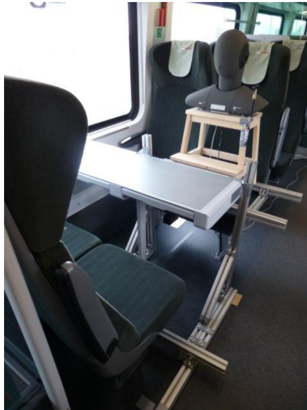
Abb. 19. Aluminium-Holzkonstruktion für die Positionierung des Kunstkopfes
