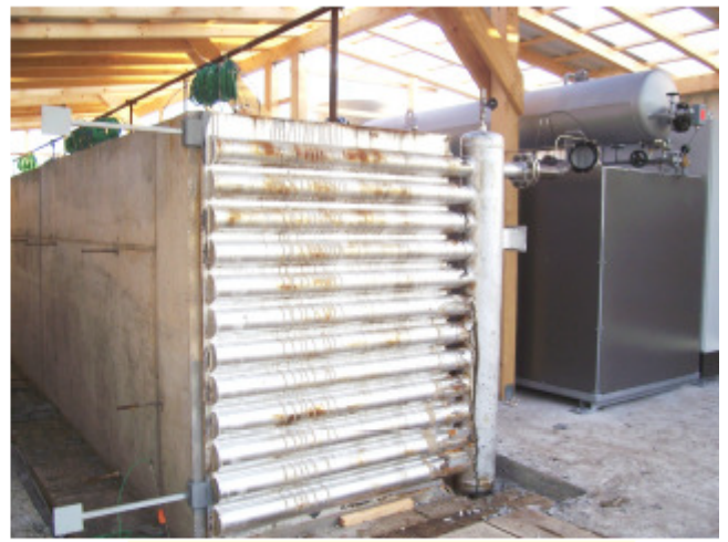
Beton – Feststoffspeicher Testspeicher DLR, Stuttgart 100 kW, 400 kWh Testbetrieb 2006
