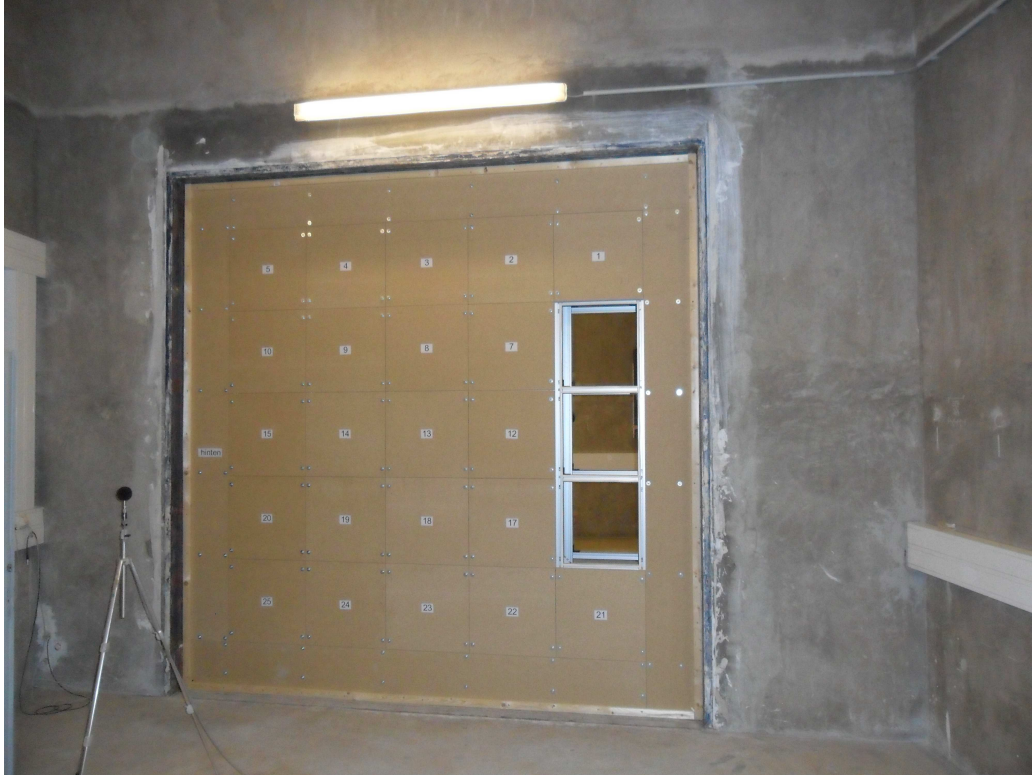
Abb. 24: Senderraumseitige Ansicht der Testwand. Der Blick durch die Öffnung (es fehlen die Platten Nr. 6, 11 und 16) lässt die beiden Raster erahnen. Rechts neben der Öffnung ist der 30 cm breite, umlaufende Rahmen erkennbar.
