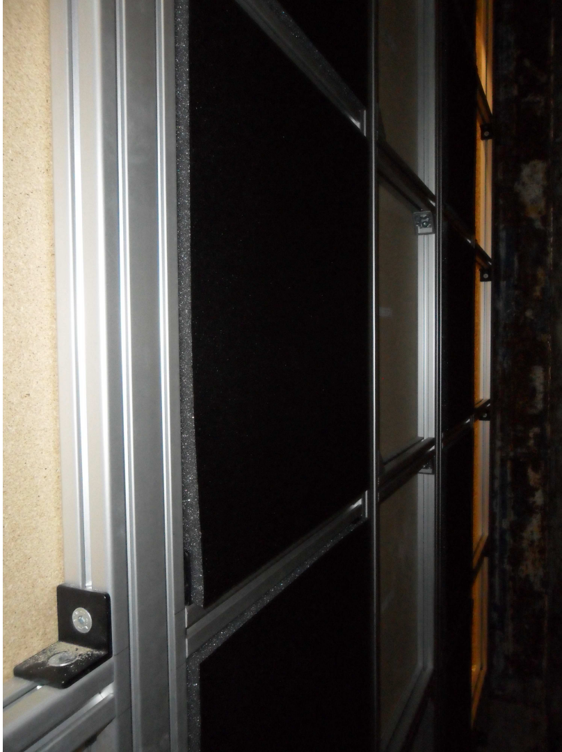
Abb. 29: Die Innenseite der Empfangsschale. Man erkennt die Stützkonstruktion, die darauf montierten Spanplatten und das von innen auf die Platten geklebte Absorptionsmaterial.
