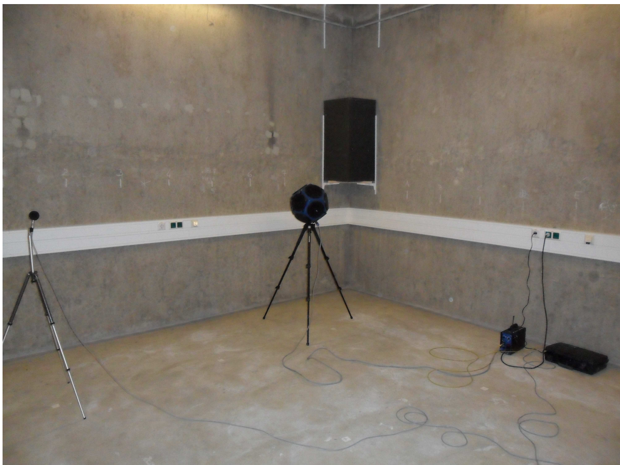
Abb. 30: Mikrofon, Lautsprecher, Verstärker und Messkoffer (v. l. n. r.). Schaumstoffprismen, wie jenes im Hintergrund, dienen im Empfangsraum der Anpassung der Nachhallzeit.
