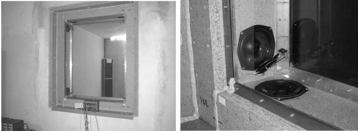
Abb. 8: Die ANC-Fenster enthalten in jeder Ecke ein Mikrofon und zwei Antischall-Lautsprecher. [Jakob & Möser 2003]
