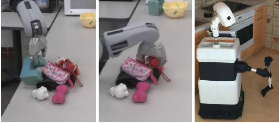
Abb. 9. Greifen beliebiger Objekte: Links und Mitte: zwei Beispiele zum Greifen unbekannter Objekte aus einem Haufen. Greifen erfolgt aufgrund einer greifbaren Form [4]. Rechts: Anwendung für die Unterstützung älterer Personen: der Hobbit-Roboter hebt alles vom Boden auf [3]
