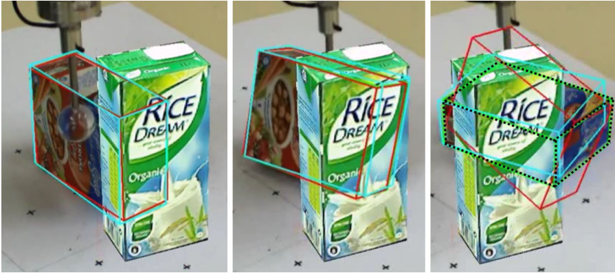
Abb. 7. Verfolgen der Pose eines Objektes mit Verdeckung und Vorhersage der wahrscheinlichen Position nach der Bewegung mit dem Roboter. Mit Hilfe einer Simulation werden physikalisch wahrscheinliche Stellungen vorausgesagt, um Hinweise zu geben, dass die Schachtel umgefallen sein könnte. Verfolgen der Bewegung mit dieser Methode ist erfolgreich, siehe punktierte Linien im letzten Bild. Dunkle/rote Linien : Verfolgung nur mit Konturen. Helle/blau Linien : Erkennung der verdeckten Konturen, um Verfolgen zu verbessern.
