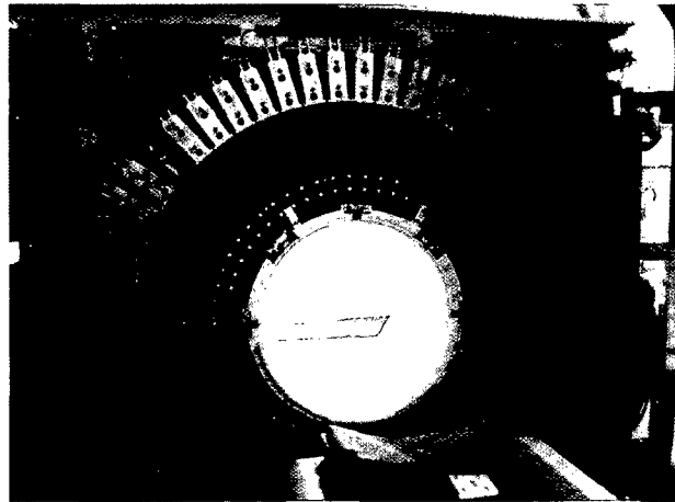
Figure 3.6: Geöffneter Vollringscanner mit Blockdetektorbauweise (GEMS Advance). Die einzelnen Sektoren mit Verstärkerelektronik sind zu erkennen. In jedem Sektor befinden sich 6 Blockdetektoren mit je 36 BGO-Kristallen. Zwischen den Detektoren und dem Patiententunnel befinden sich die Septen für den 2D-Betrieb, die im Falle von 3D-Anwendungen zum Bildhintergrund hin aus dem Gesichtsfeld transportiert werden. (Photo: Dobrozemsky)
