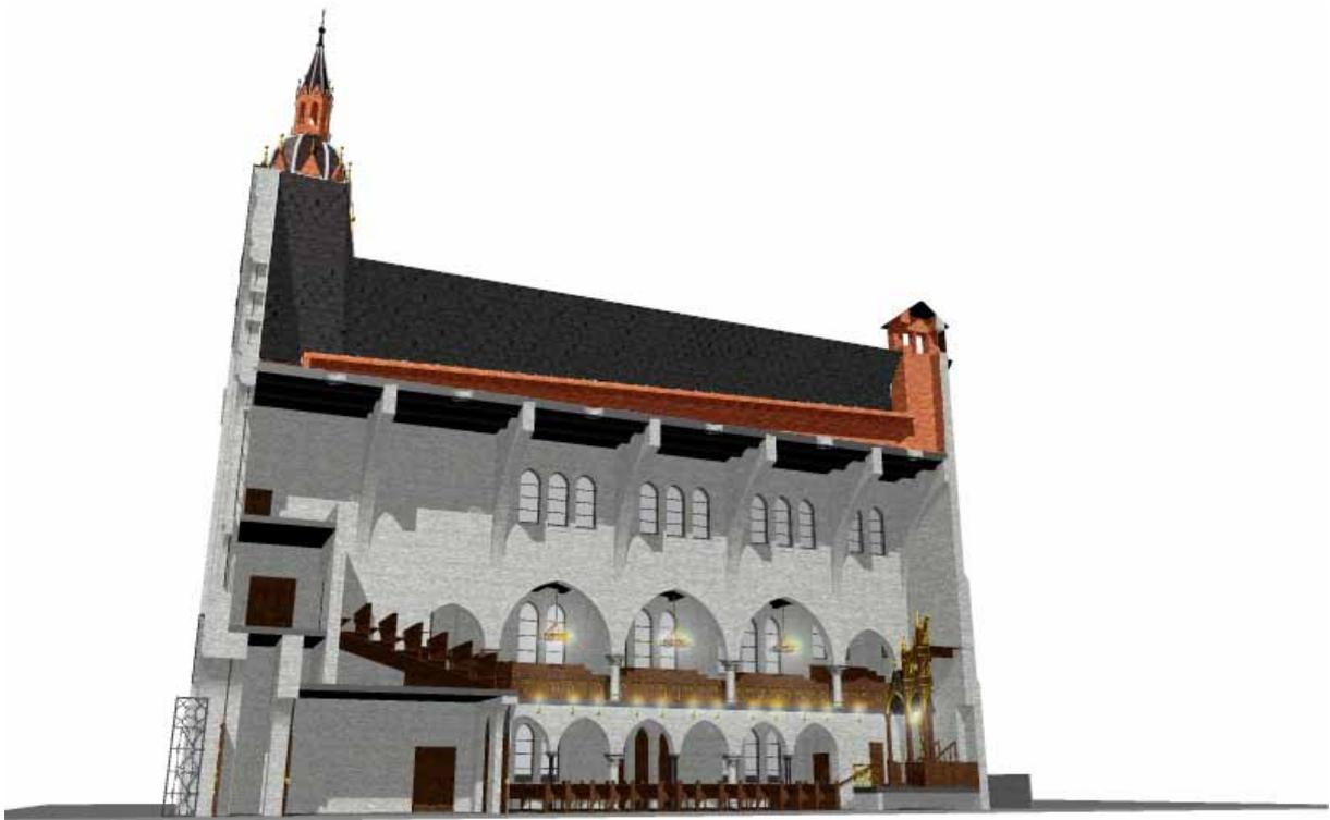
Abb. 4.86: Querschnitt durch den Baukörper
