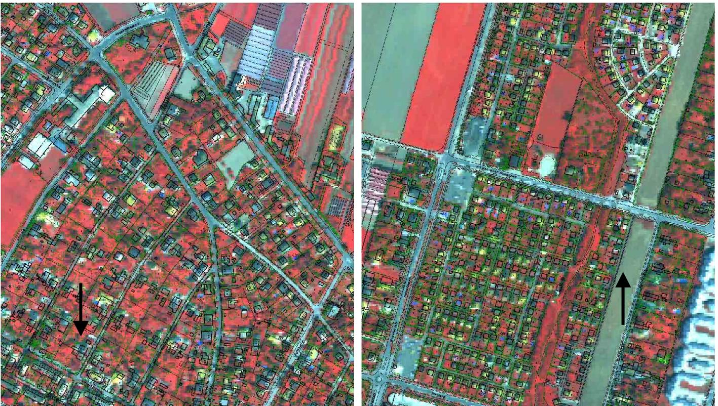
Abb. 8-24: „nurLin-50scan“: Messflug 1997, Streifen 7, Scanbereich 2700-2900: Orthophotoausschnitte mit überlagelter MZK. Die Pfeile deuten Problemstellen im Orthophoto und die Richtung der Versetzungen an.
