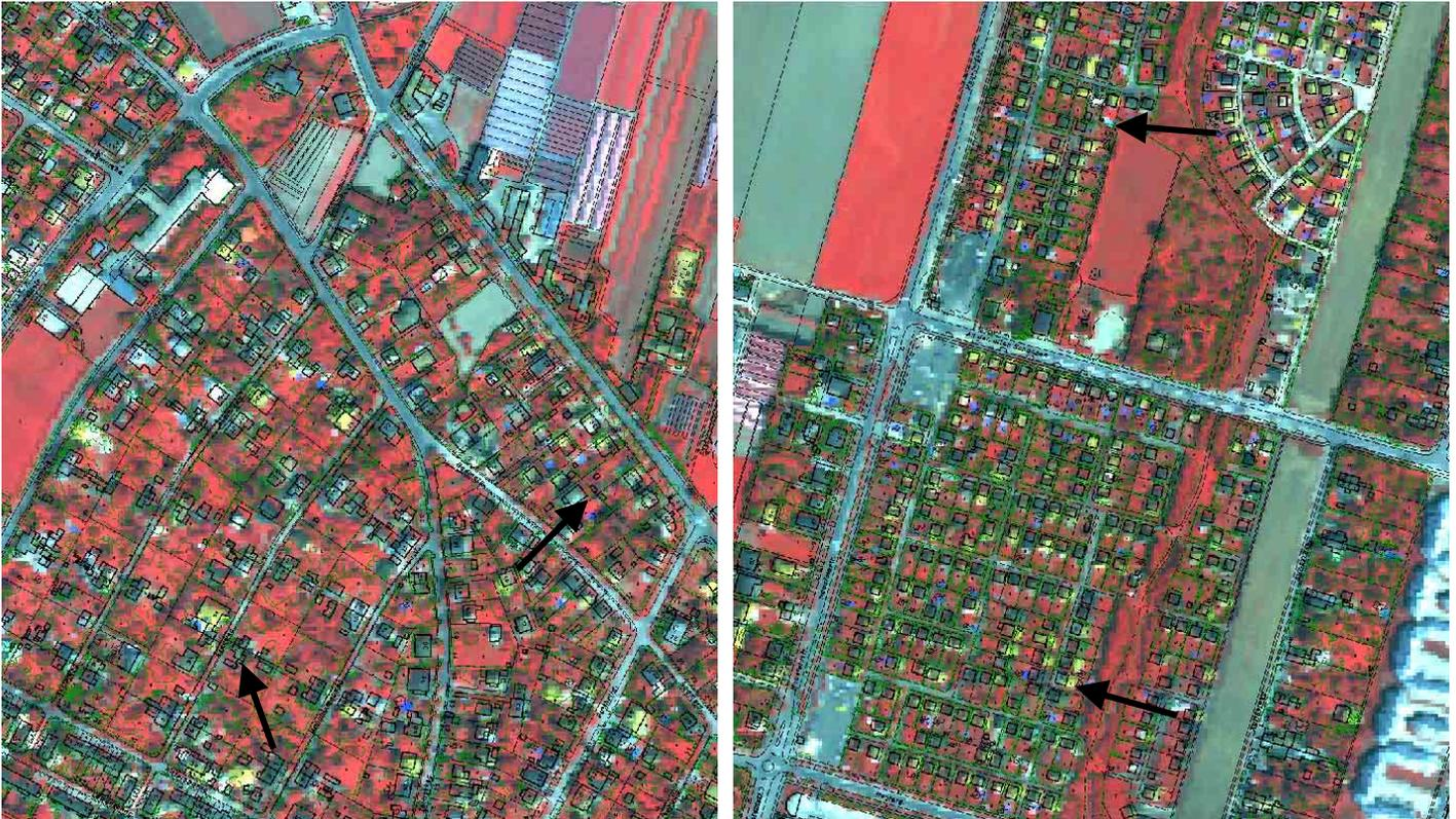
Abb. 8-14: „PP-100scan“: Messflug 1997, Streifen 7, Scanbereich 2700-2900: Orthophotoausschnitte vom linken und rechten Streifenrand mit überlagerter MZX. Die Pfeile deuten Problemstellen im Orthophoto und die Richtung der Versetzungen an.
