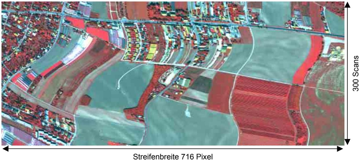
Abb. 8-4: Ausschnitt aus den ATM-Originaldaten des Messfluges 2000, aufgenommen ohne automatischer Rollwinkelkorrektur: dargestellt sind ca. 300 Scans aus Streifen 6 in Infrarot-Kanalkombination 6/4/2.
