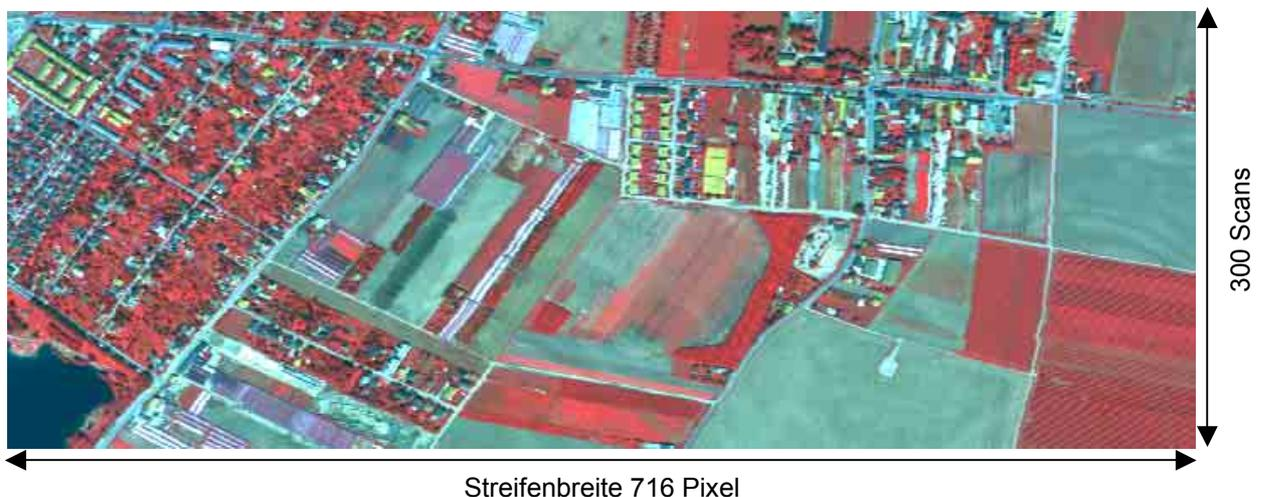
Abb. 8-3: Ausschnitt aus den ATM-Originaldaten des Messfluges 1997, aufgenommen mit aktiver automatischer Rollwinkelkorrektur: dargestellt sind ca. 300 Scans aus Streifen 6 in Infrarot-Kanalkombination 6/4/2.
