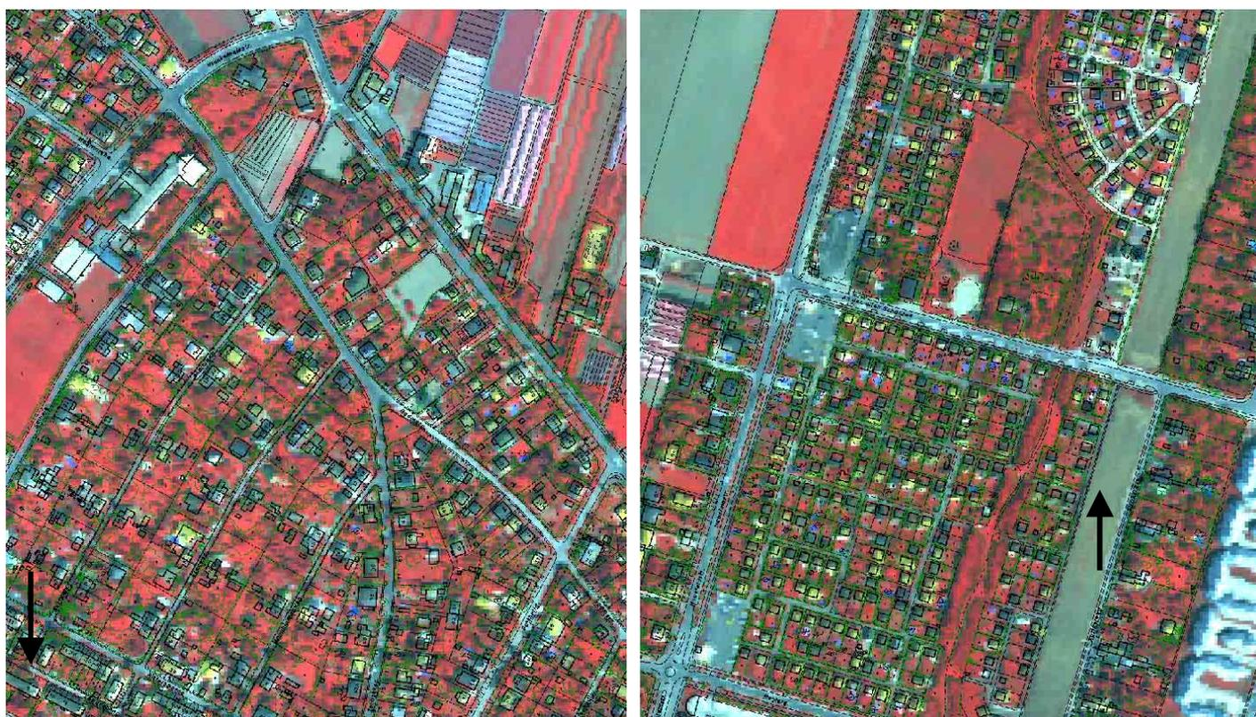
Abb. 8-22: „Lin-50scan“: Messflug 1997, Streifen 7, Scanbereich 2700-2900: Orthophotoausschnitte vom linken und rechten Streifenrand mit überlagerter MZK. Die Pfeile deuten noch Rest-Problemstellen im Orthophoto und die Richtung der Versetzungen an.
