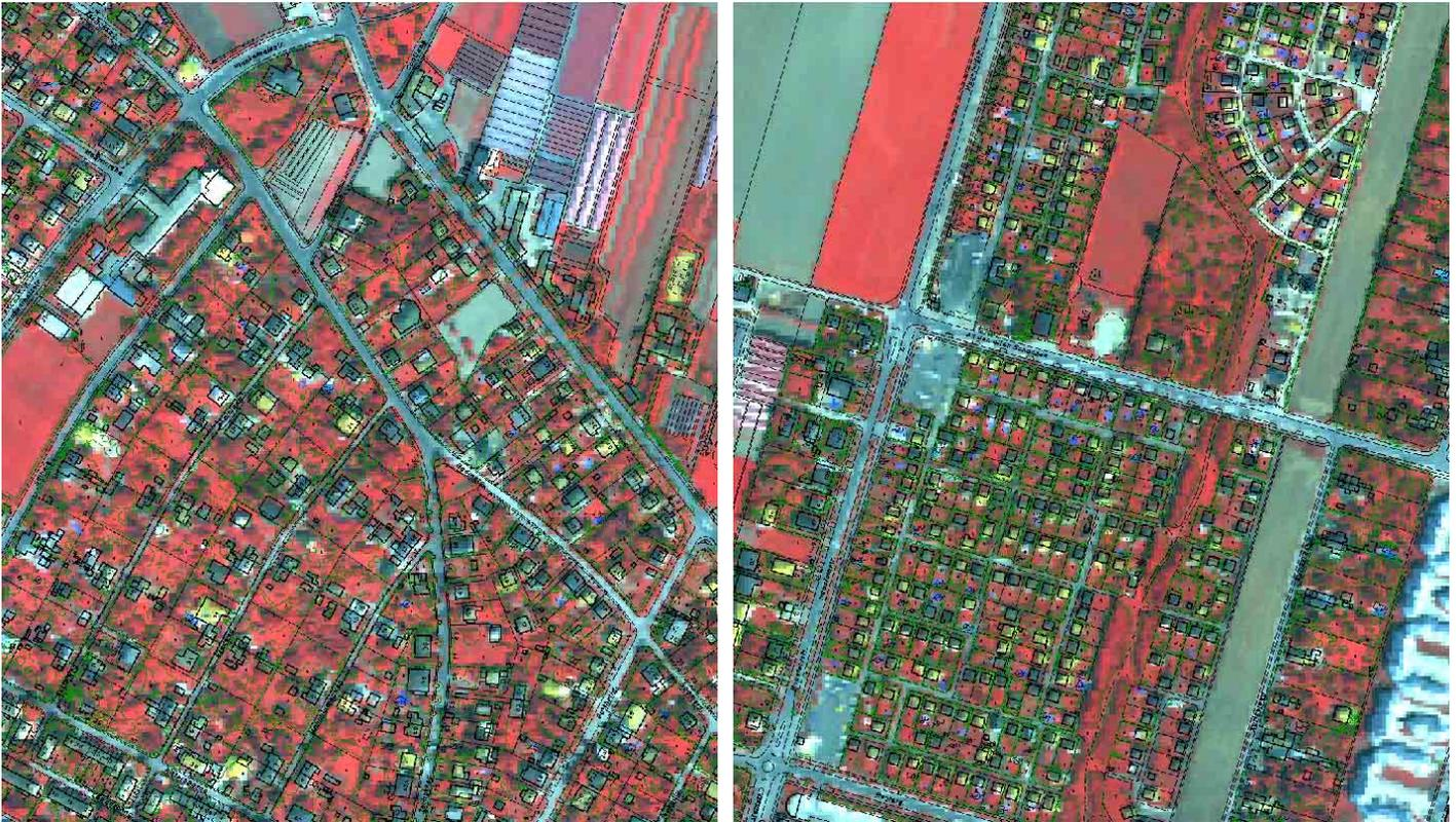
Abb. 8-16: „PP-50scan“: Messflug 1997, Streifen 7, Scanbereich 2700-2900: Orthophotoausschnitte vom linken und rechten Streifenrand mit überlagerter MZK; es sind kaum Versetzungen mehr zu erkennen.
