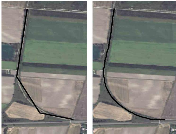
Abb. 8-8: Semi-automatische Linienmessung mit Snakes:
