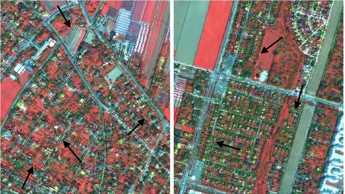
Abb. 8-18: „Lin-200scan“: Messflug 1997, Streifen 7, Scanbereich 2700-2900: Orthophotoausschnitte vom linken und rechten Streifenrand mit überlagerter MZK. Die Pfeile deuten Problemstellen im Orthophoto und die Richtung der Versetzungen an.
