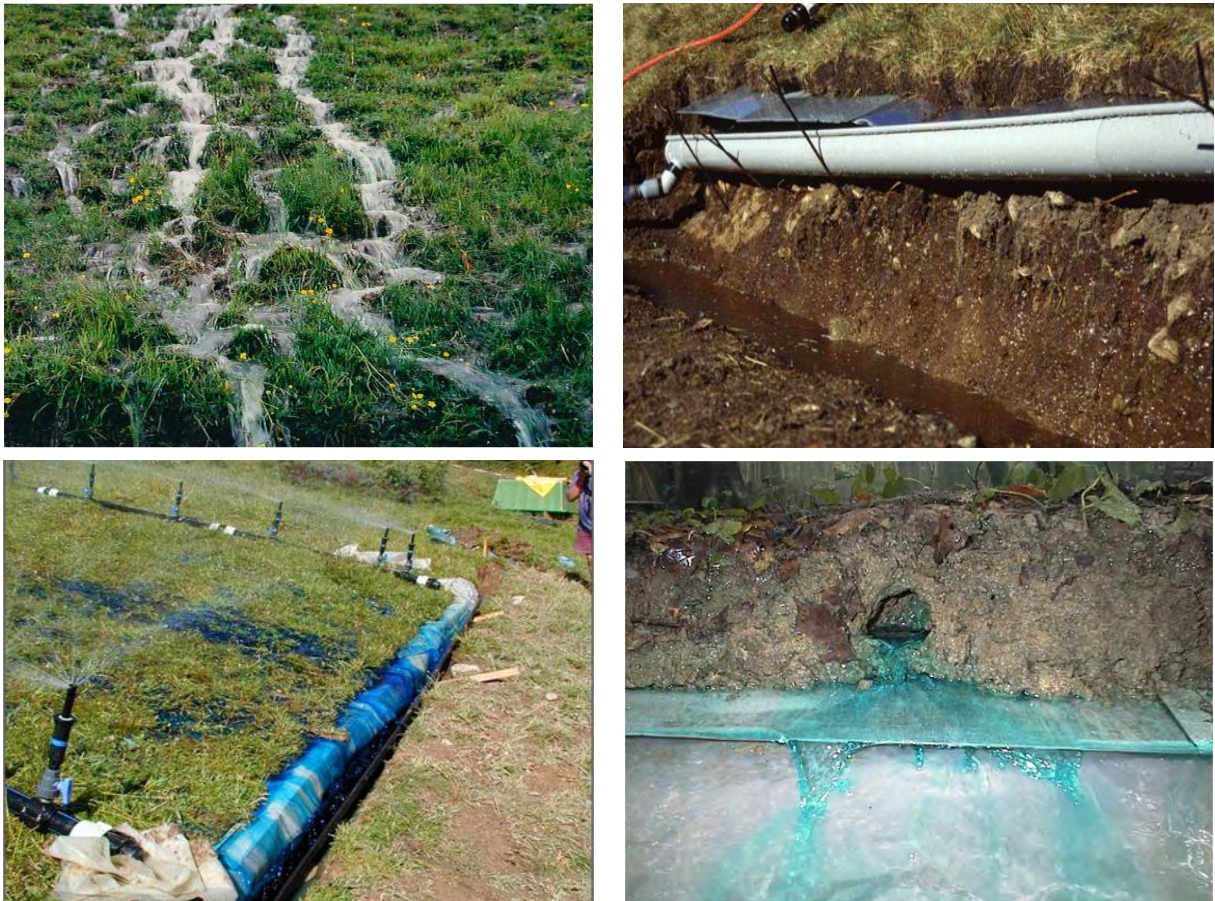
Abb. 4: Messung der Abflussgeschwindigkeit: a) und c) rascher Oberflächenabfluss, b) langsamer Interflow, d) rascher Interflow – Channel flow
