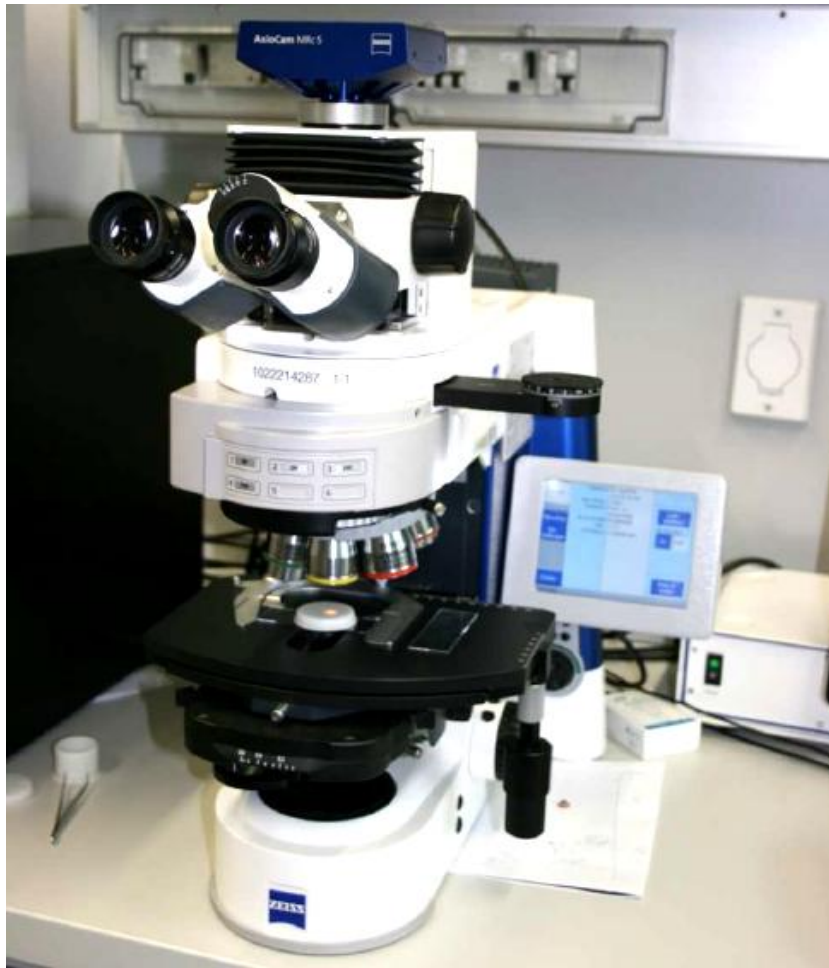
Abb. 6.6: Axiomager M1m Mikroskop mit der AxioCam MRC 5 Quelle: [37]
