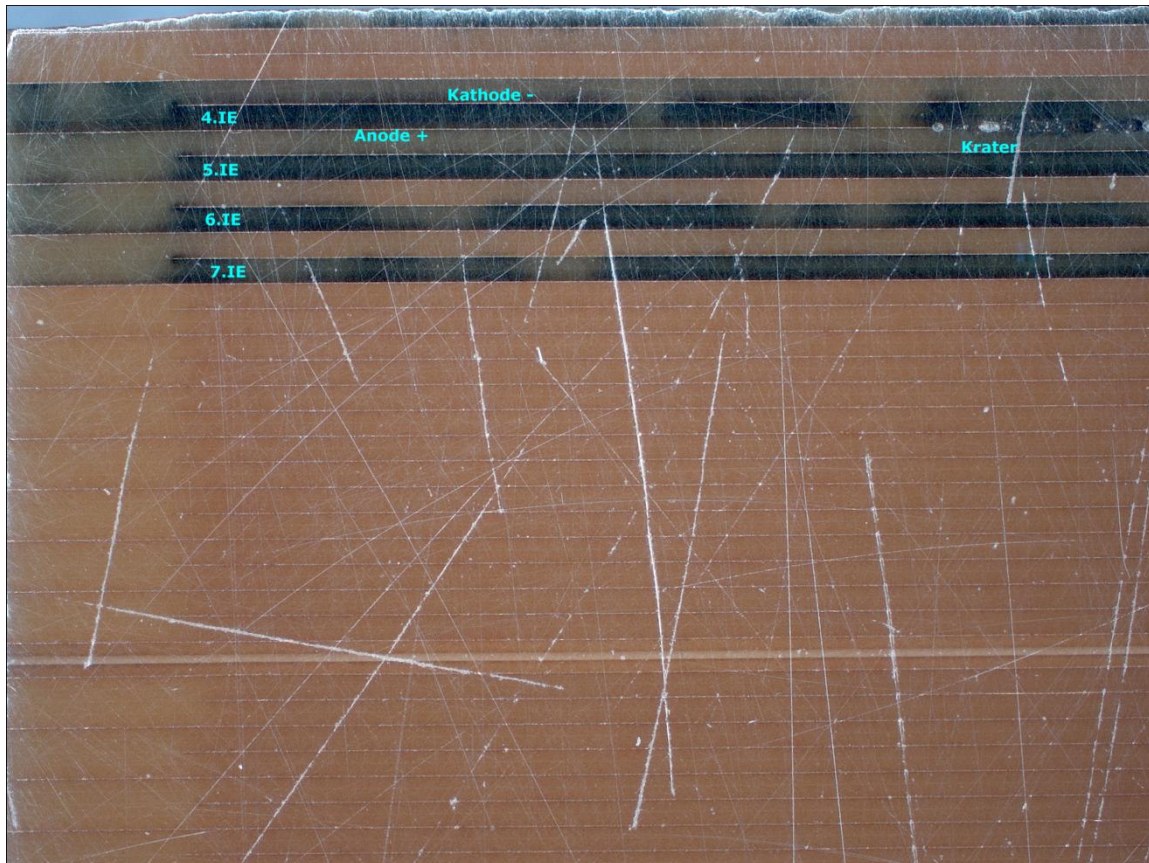
Abb. 7.59: Linke Oberseite von EpB nach der Degradation. Die 4.IE wurde eine Stunde bei 550° C und 50V belastet. 5.IE, 6.IE und 7.IE wurden für eine halbe Stunde degradiert. Dunkelfeld, 5-fache Vergrößerung
