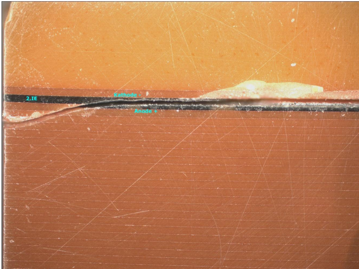
Abb. 7.18: Linke Unterseite von EpB nach der 2.Degradation. Bruch nach geschliffenem 426 \mu\text{m} entlang des Risses. Dunkelfeld, 5-fache Vergrößerung
