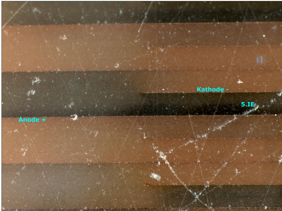
Abb. 7.57: Linke Oberseite von C4 nach 6-stündiger Degradation bei 550° C und 45V. Dunkelfeld, 20-fache Vergrößerung
