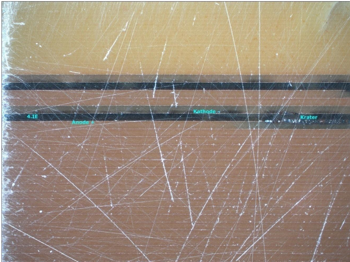
Abb. 7.22: Linke Unterseite von EpA nach geschliffenem 259 µm. Entlang der Anode ein langer Krater. Dunkelfeld, 5-fache Vergrößerung
