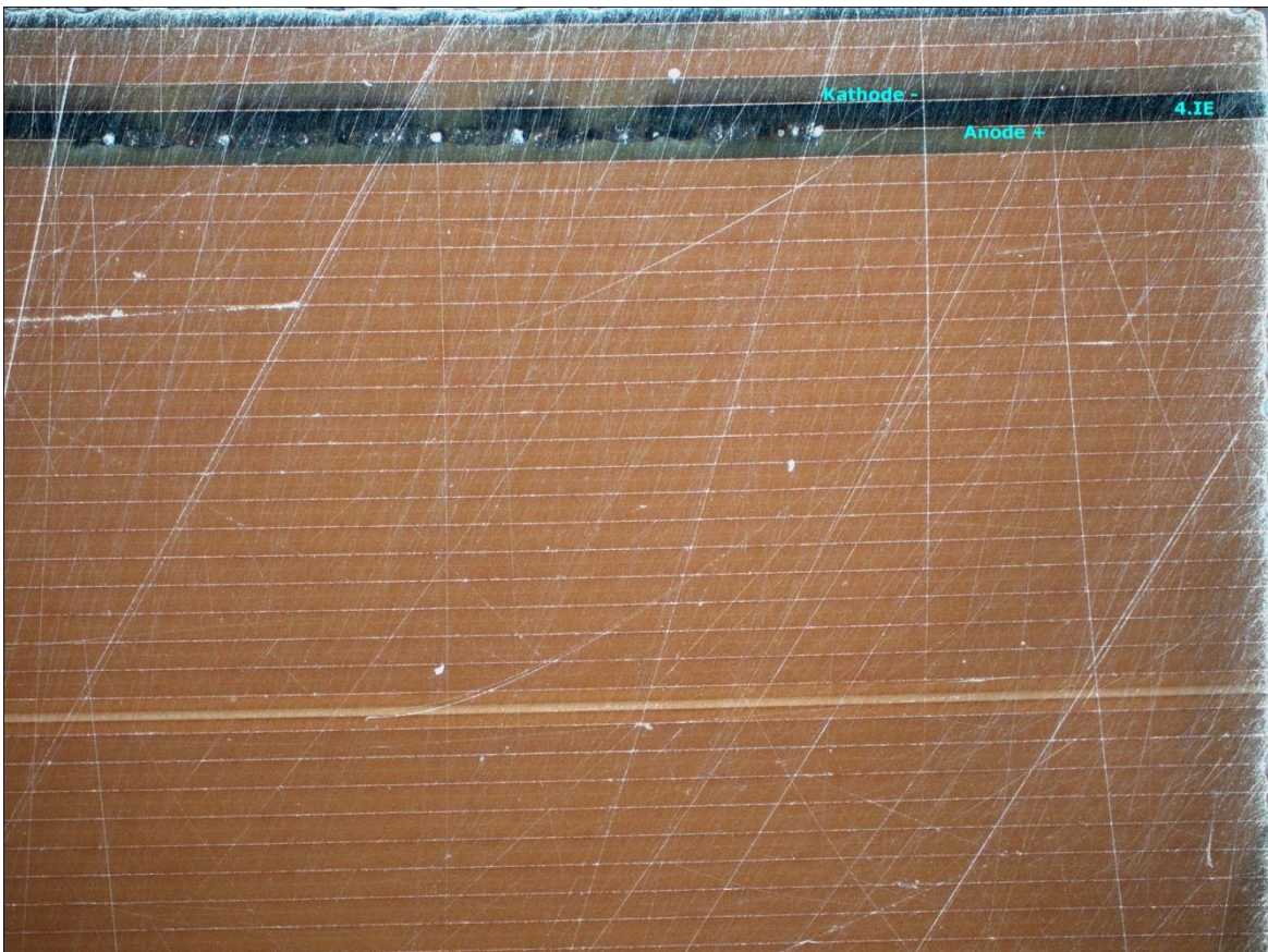
Abb. 7.21: Rechte Oberseite von EpB nach geschliffenem 2050 µm. Entlang der Anode ein langer Krater. Dunkelfeld, 5-fache Vergrößerung
