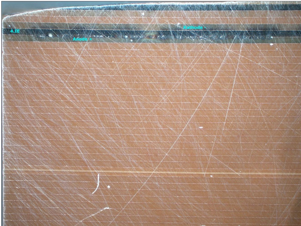
Abb. 7.20: Linke Unterseite von EpB nach geschliffenem 2050 µm. Entlang der Anode ein langer Krater. Dunkelfeld, 5-fache Vergrößerung
