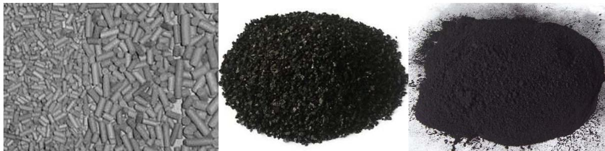
Abbildung 7: Aktivkohle in granulierter, körniger und Pulverform
