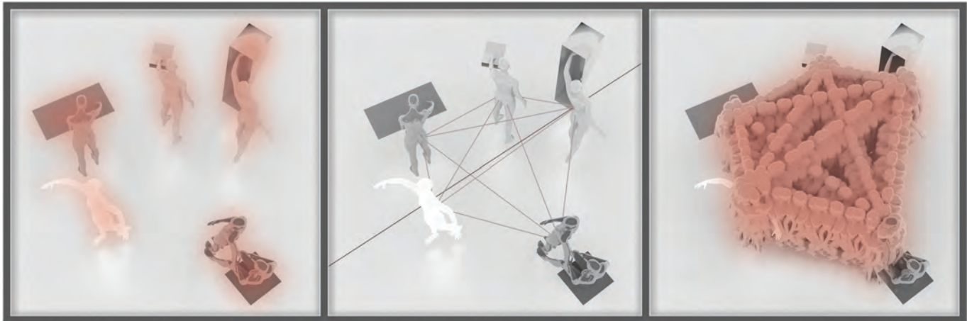
Abb. 13: Schritte der Verbindungen: 1. Freie Positionierung der Figuren, Volumina und Flächen im Raum (links) 2. Verbinden der solitären Figuren gemäß der Freiheitsgrade (automatisierter Ablauf) und Erzeugung der Punktergebnisierenden (Mitte) 3. Darstellung des tatsächlich notwendigen Raumvolumens der Wege (Bewegungsprofil) anhand der „gehenden Figur“ (rechts)
