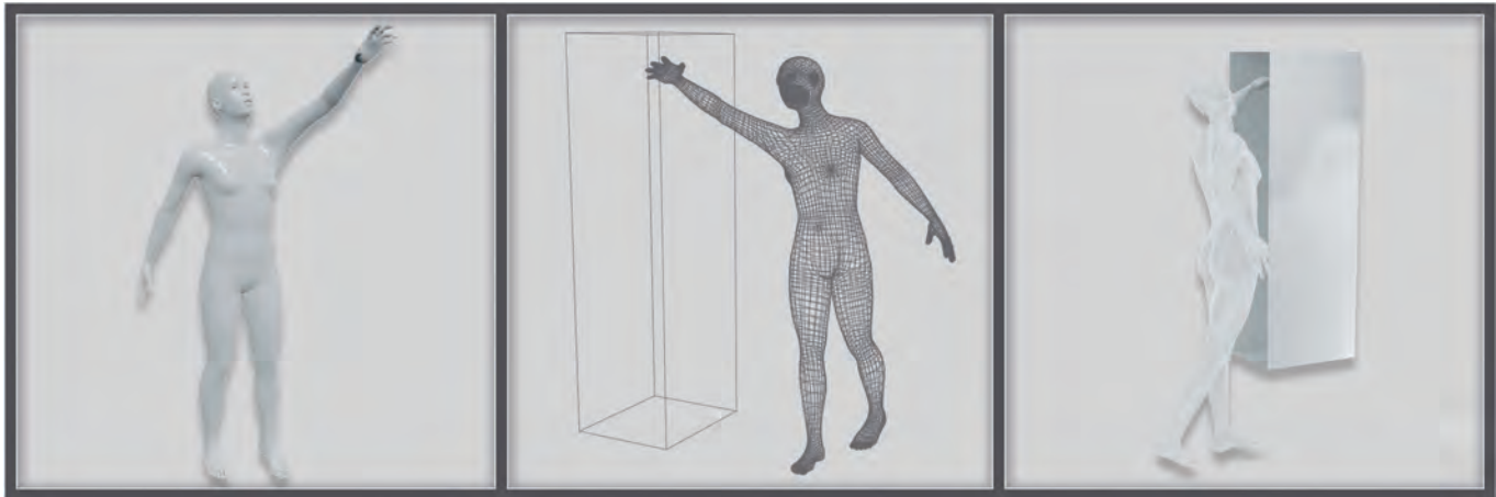
Abb. 11: Schritte der finalen Modellierung: 1. Import der Figuresätze in ein CAD-Programm (Rhinoceros) 2. Erstellung aller gewünschten Volumina und Flächen 3. Fertiggestellte Figur mit dazugehörigem Volumen auf vollständiger 3-d Datenbasis
