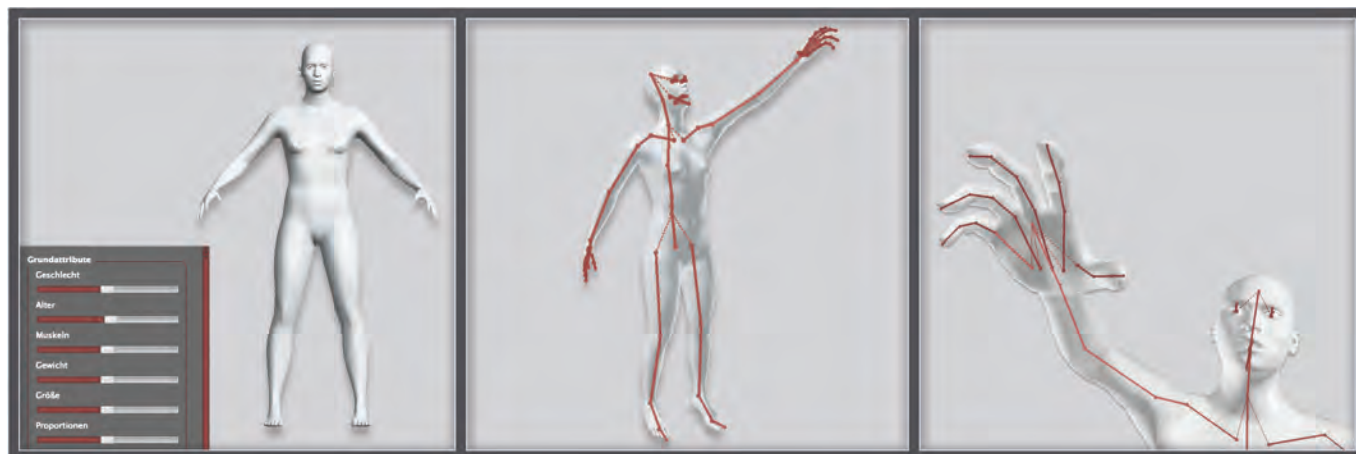
Abb. 10: Schritte der Figurenerstellung: 1. Festlegung der Körperproportionen in MakeHuman (links) 2. Bearbeitung des KnochengeriPPes in Blender und Definition der verschiedenen Bewegungen (Mitte) 3. Detail des KnochengeriPPes in Blender (rechts)
