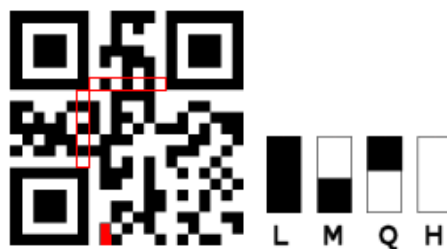
Abbildung 3.2: QR Code Elemente: Fehlerkorrektur-Stufe & Matrix-Linie
