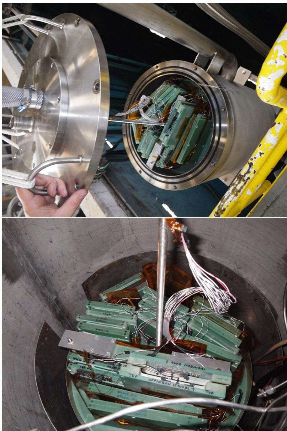
Abbildung 27: Detektoren mit angeschlossener Bias-Spannungsversorgung in RITA (*Radio Isotope Test Arrangement*)
