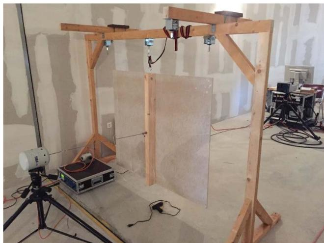
Abbildung 17: Prüfkörper zur Charakterisierung des Schwingungsverhaltens von Bauteilverbindungen
