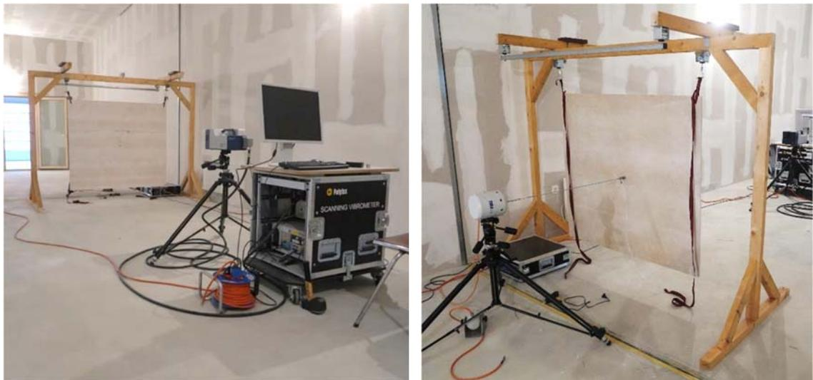
Abbildung 14: Darstellung der Konstruktion zur Abhängung der Probekörper und des Versuchsaufbaus
