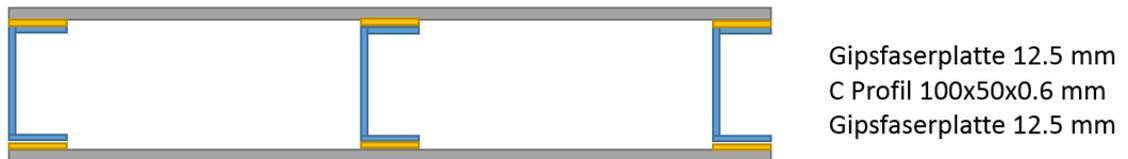
Abbildung 72: Schematische Darstellung des untersuchten Bauteils (1.25m x 1.50m) mit Klebeverbindung
