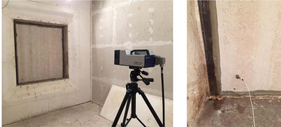
Abbildung 15: Messaufbau zur Untersuchung des Luftschalldämmmaßes.
