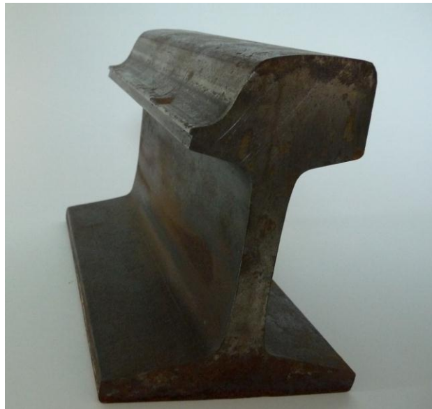
Abbildung 1-3: Schienenprofil einer R260-Schiene mit seitlichem Verschleiß bei der Wiener U-Bahn
