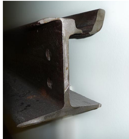
Abbildung D-20: a) Seitenverschleiß an einer Vignolschiene, b) Höhenverschleiß an einer Rillenschiene
