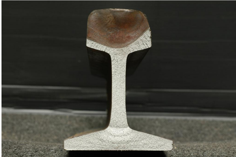
Abbildung D-2: Bruchfläche einer aufgebrochenen Schiene
