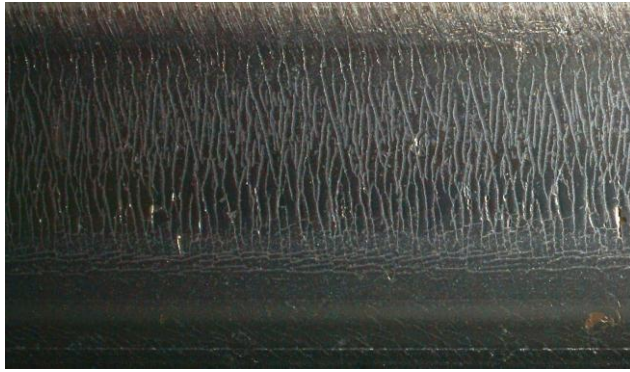
Abbildung 4-39: a) auf einer kopfgehärteten R350HT-Schiene der Wiener U-Bahn Quasi-parallel quer zum Schienenkopf laufende weiße Linien, die sich am Rande teilweise vereinigen (die schrägen Risse am unteren Bild gelten als klassische Head Checks), b) Rissmuster auf einer Schiene zufolge unterschiedlicher Schlupfrichtung der vorlaufender und nachlaufender Achse (Fahrkante unten) (Magel et al. o.J.)
