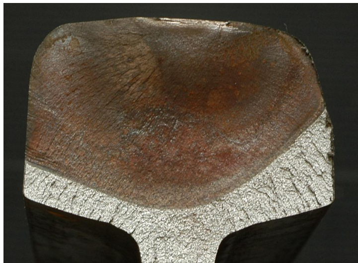
Abbildung 4-43: Bruchfläche im Kopf einer R350HT-Schiene der Wiener U-Bahn, man erkennt die gesamte von Rost angegriffene Ermüdungsbruchfläche, der glänzende Teil ist die gewaltsam aufgebrochene Restbruchfläche
