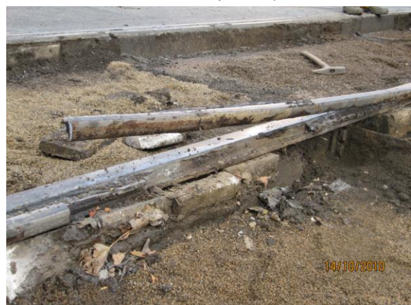
Abbildung D-13: Ermüdungsbruch des Leitschenkels (Rillenkopfes) einer eingebetteten Rillenschiene (nicht mehr befahrbar!), a) im eingebauten Zustand, b) mit entfernten Großflächenplatten
