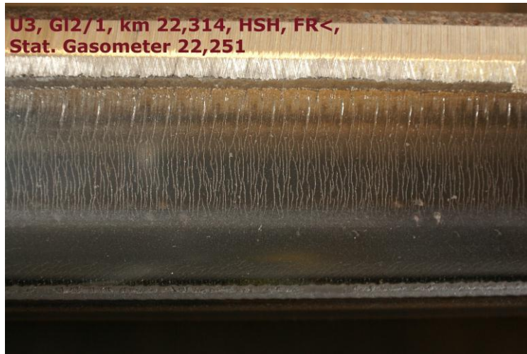
Abbildung 1-8: Weiße Linien verlaufen nahezu parallel quer zur Schiene und fallen oft an beiden Enden des Fahrspiegels zusammen
