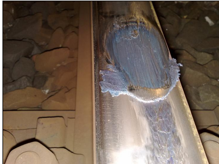
Abbildung 1-5: Schleuderstelle eines durchdrehenden Rades
