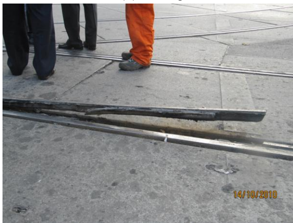
Abbildung D-13: Ermüdungsbruch des Leitschenkels (Rillenkopfes) einer eingebetteten Rillenschiene (nicht mehr befahrbar!), a) im eingebauten Zustand, b) mit entfernten Großflächenplatten
