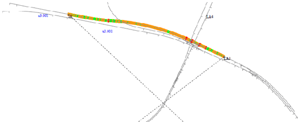
Abbildung 3-6: Ausschnitt aus einer Übersichtsdarstellung der Auswertung der Messergebnisse (siehe Anhang F) mit einer farblichen Zuordnung der Messwerte, grün (Zustand B) = Überschreitung der Aufmerksamkeitsschwelle (AS), gelb/orange (Zustand C) = Überschreitung der Eingriffsschwelle (ES) und rot (Zustand D) = Überschreitung der Soforteingriffsschwelle (SES)
