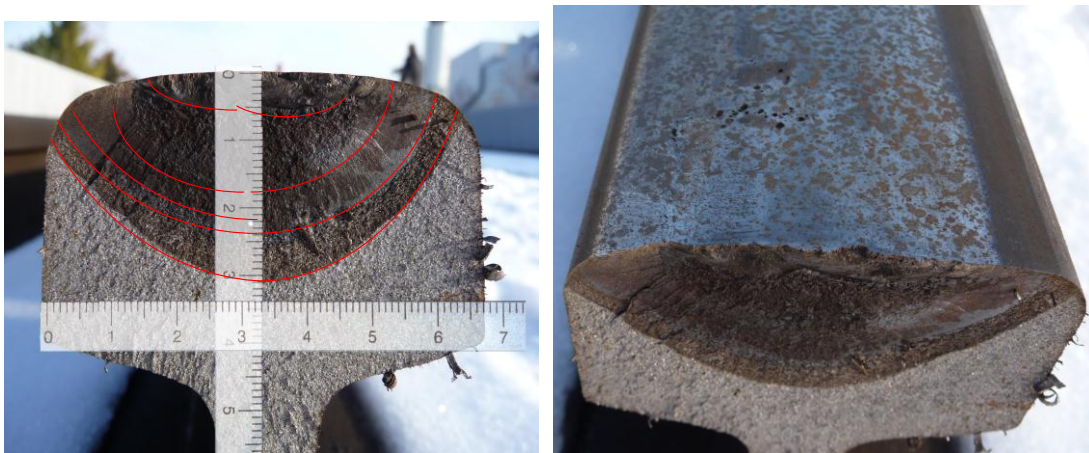
Abbildung 5-8: Bruchfläche und Oberfläche einer S48U-Schiene der Güte R350HT
