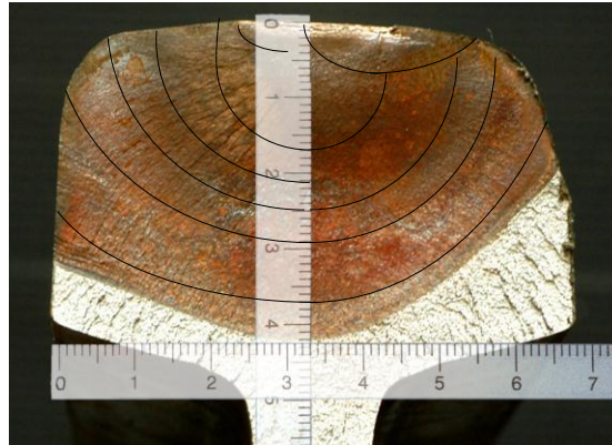
Abbildung 5-7: Foto einer Bruchfläche infolge einer Ermüdungsrissausbreitung (die dunkle Fläche stellt die Ermüdungsrissausbreitung dar und die helle Fläche den restlichen Gewaltbruch)
