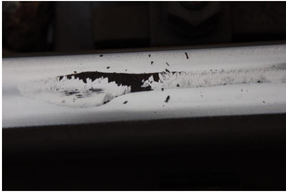
Abbildung D-22: b) Schienenbruch zufolge a) Oberflächenschädigung durch durchdrehende Räder
