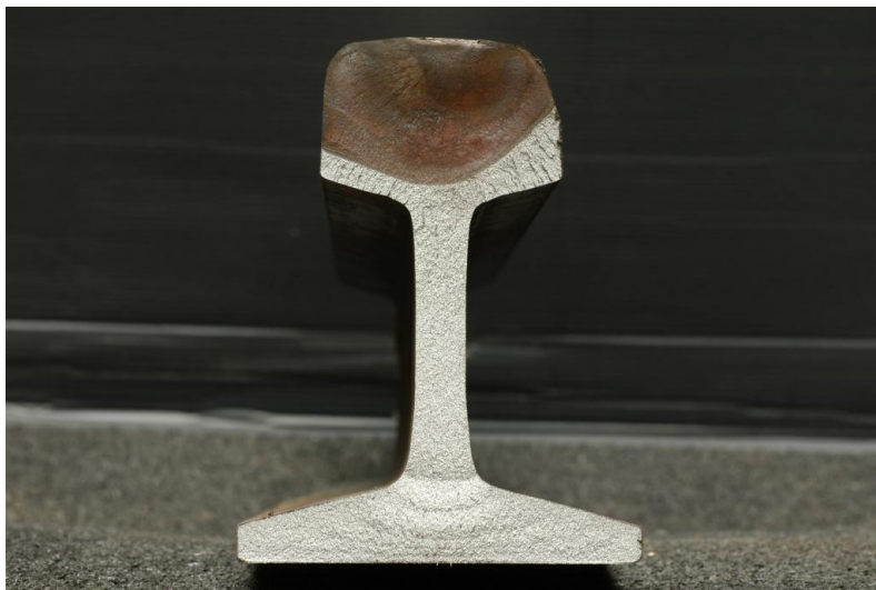
Abbildung D-3: Detailansicht der Bruchfläche der aufgebrochenen Schiene (siehe Abbildung D-2)
