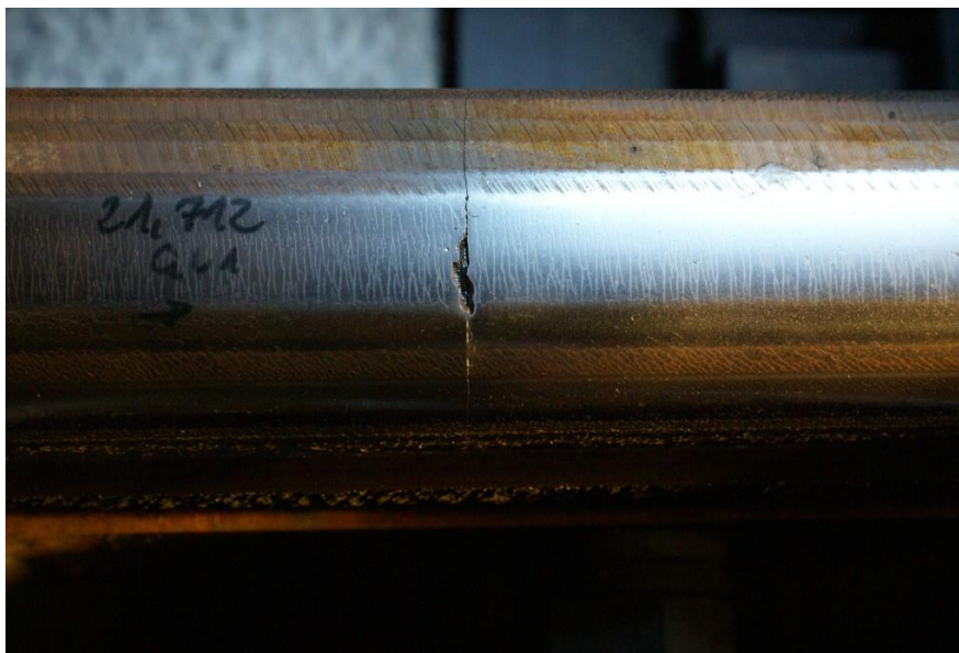
Abbildung 1-11: Oberflächenfehler, der sich im Schienenkopf zu einem Riss ausgeweitet hat.
