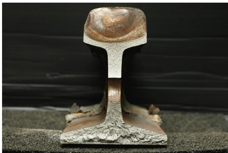
Abbildung D-4: Bruchfläche einer aufgebrochenen Schiene
