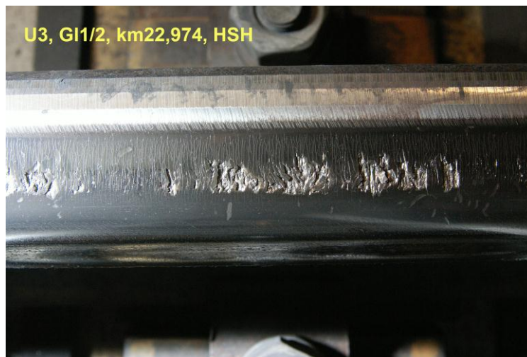
Abbildung 1-9: Weiße Linien mit balkenähnlichen Ausbrüchen auf dem Fahrspiegel
