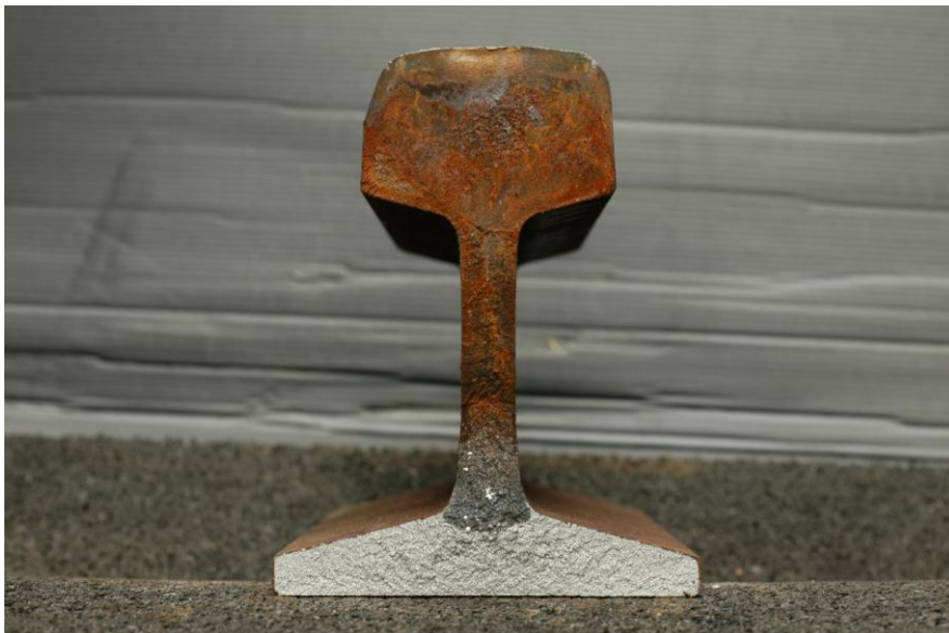
Abbildung D-6: Bruchfläche einer aufgebrochenen Schiene
