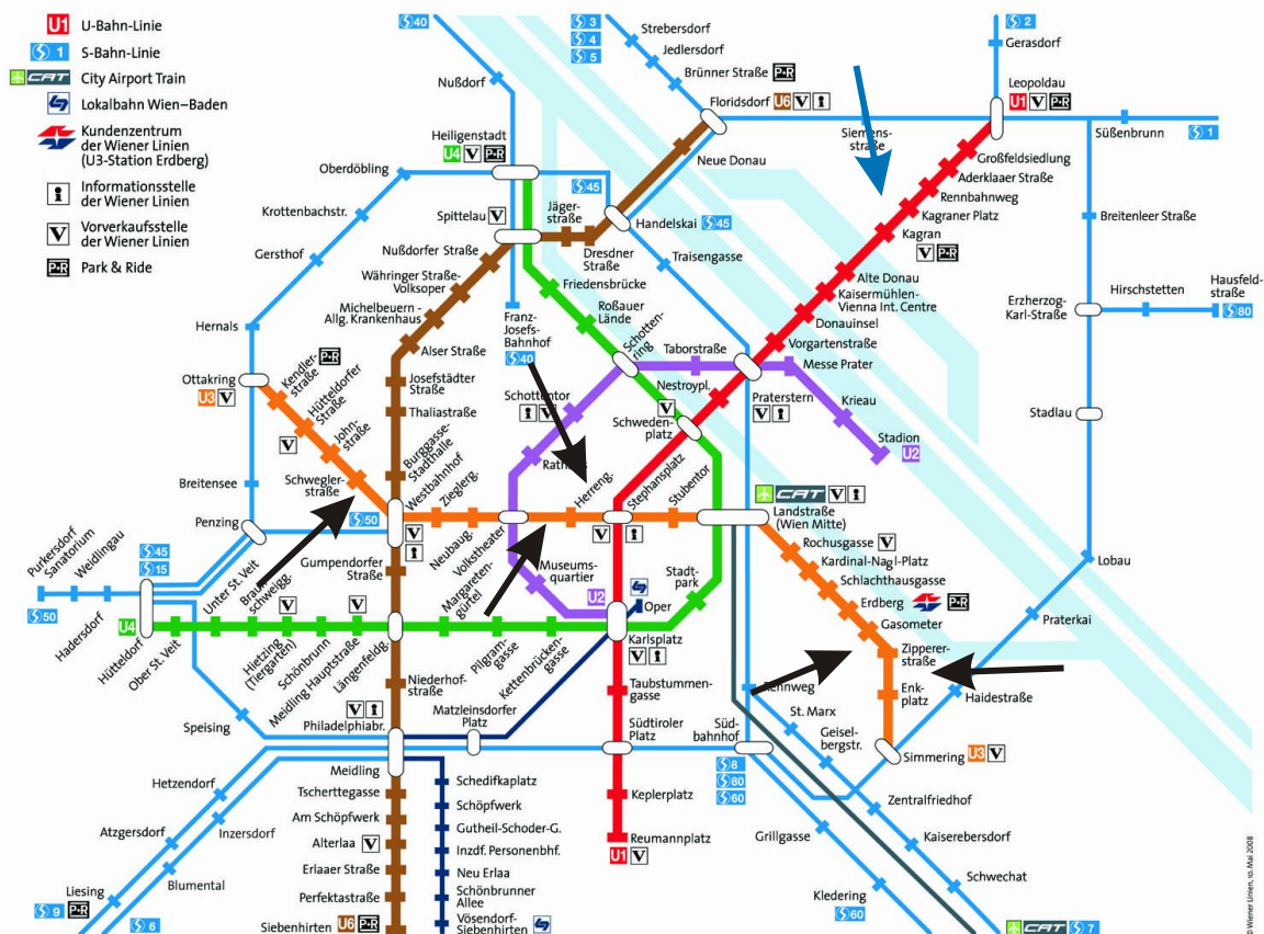
Abbildung D-1: Wiener U-Bahnnetz, die schwarzen Pfeile auf der U3 kennzeichnen die Bereiche in denen Schienenrisse und Schienenbrüche aufgetreten sind, der blaue Pfeil auf der U1 kennzeichnet einen Schienenbruch zufolge einer Schleuderstelle
