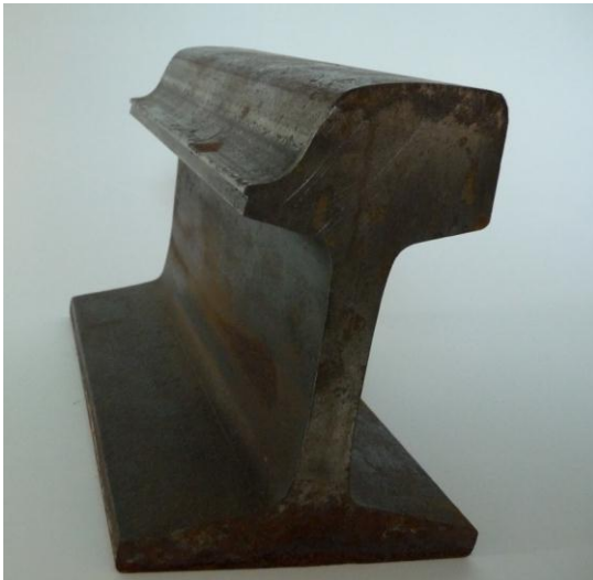
Abbildung D-20: a) Seitenverschleiß an einer Vignolschiene, b) Höhenverschleiß an einer Rillenschiene
