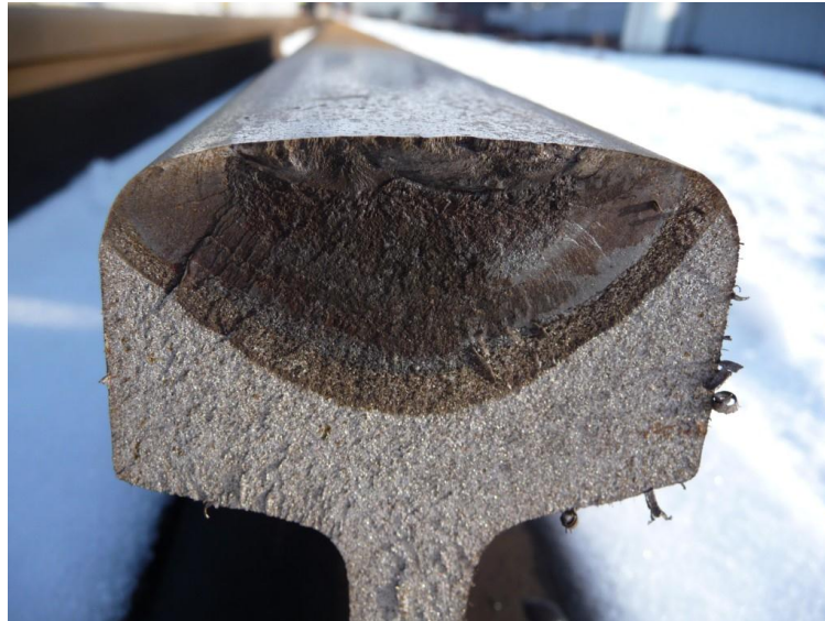
Abbildung 1-12: Ausbildung eines Durchrisses ausgehend von einem lang gezogenen Oberflächenfehler. Dieser Riss führte zum Bruch der Schiene.
