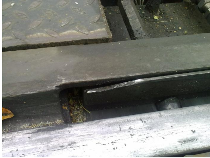
Abbildung D-17: Abgebrochene Zungenspitze einer Rillenschiene
