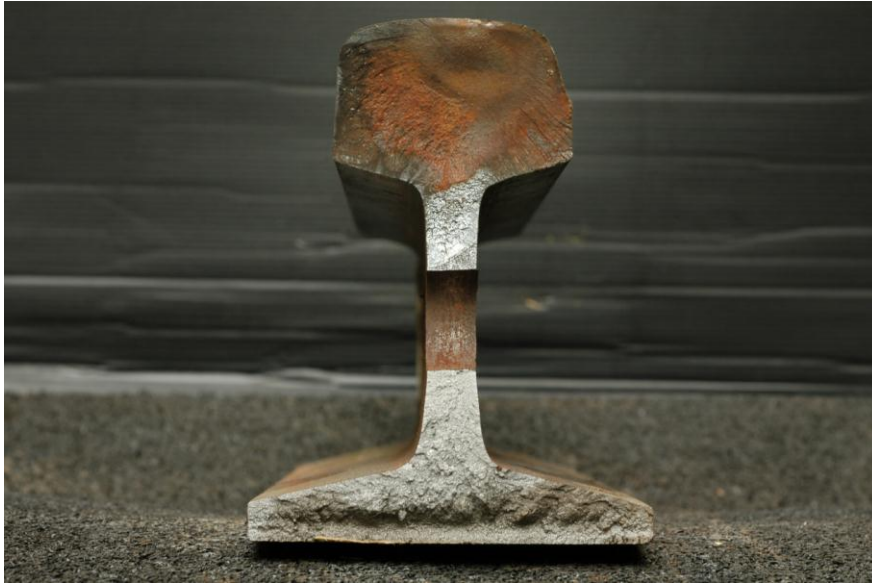
Abbildung D-5: Bruchfläche einer aufgebrochenen Schiene
