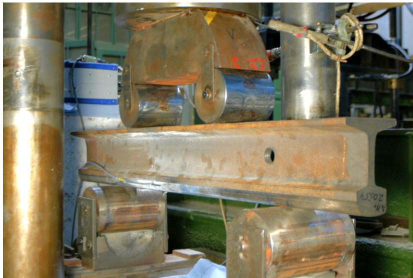
Abbildung 5-9: 4-Punkt-Auflage der Schwingungsprüfung einer S48U-Schiene der Güte R350HT mit Rollkontakt-Ermüdungsrissen am Fahrspiegel wie in Abbildung 5-10 ersichtlich
